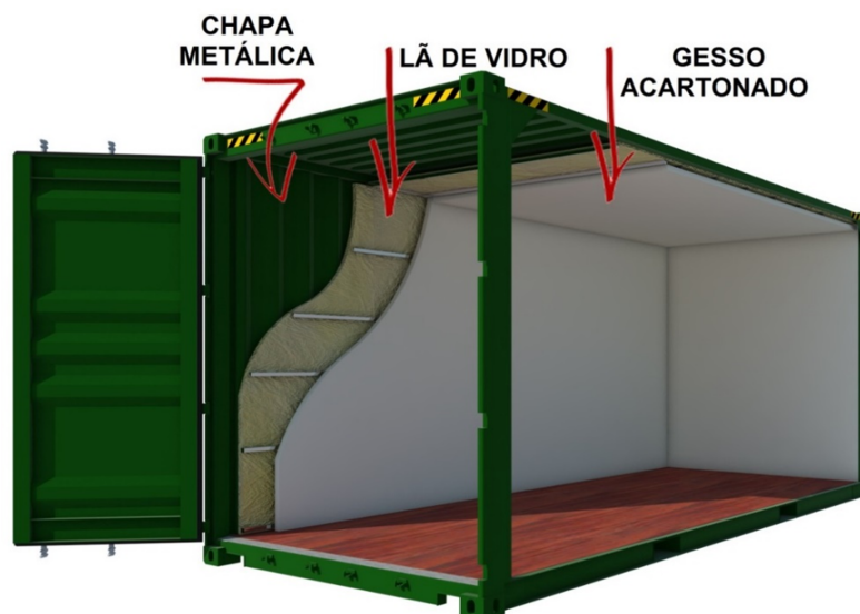
Figura 6 - Revestimentos do container
