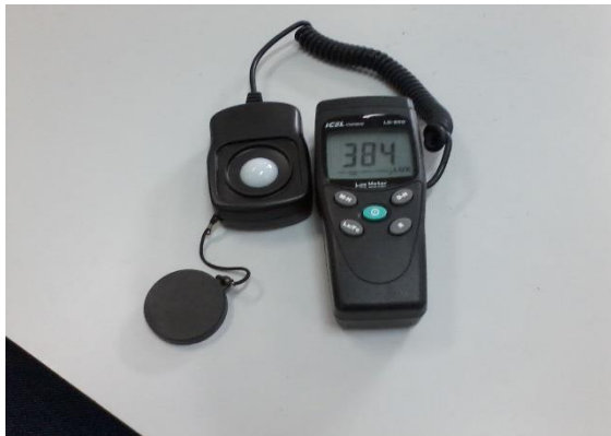
Figura 31. Imagem luxímetro ICEL Manaus LD-550 (Lux Mester).
