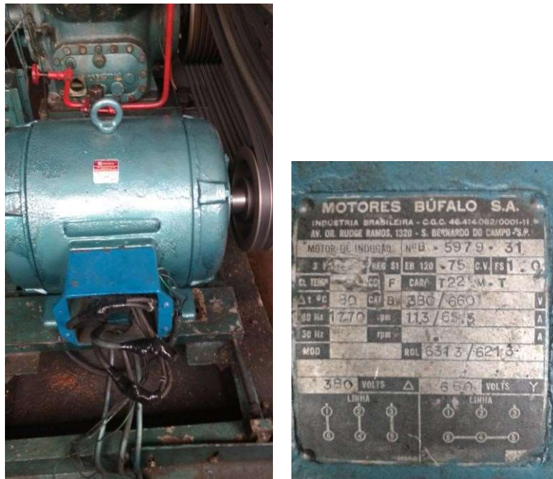
Figura 4.1 – Vista geral do motor e dados de placa
