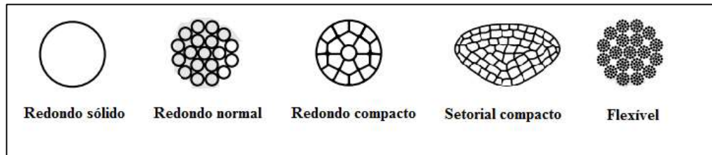
Figura 1 – Tipos de construção de condutores
