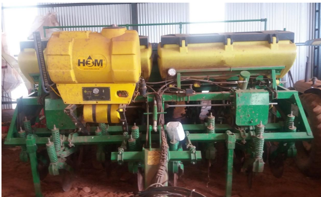
Figura 6 - Vista frontal da semeadora adaptada com pulverizador para inoculação dirigida no sulco.
