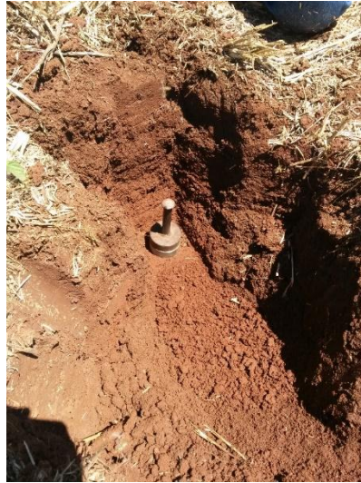
Figura 7 - Coleta realizada utilizando o método de “Coleta de anel volumétrico”.
