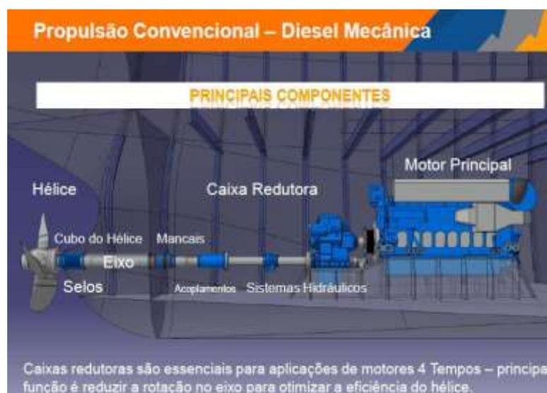
Figura 11 – Propulsão diesel – mecânica.
