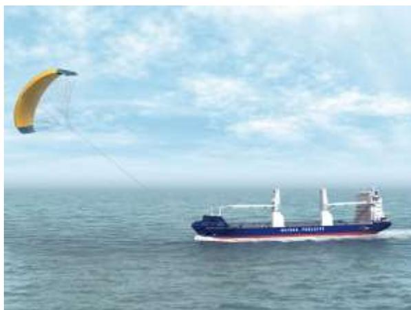
Figura 10 – Navio com propulsão híbrida, eólica - mecânica
