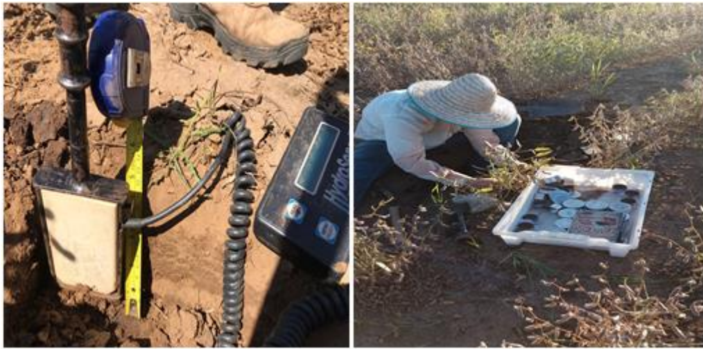
Figura 17 – Determinação da umidade utilizando TDR e coleta de amostras indeformadas de solo para determinação da umidade gravimétrica.
