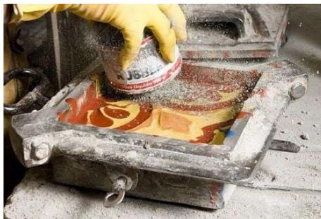
Figura 24 - Colocação da segunda camada, secante
