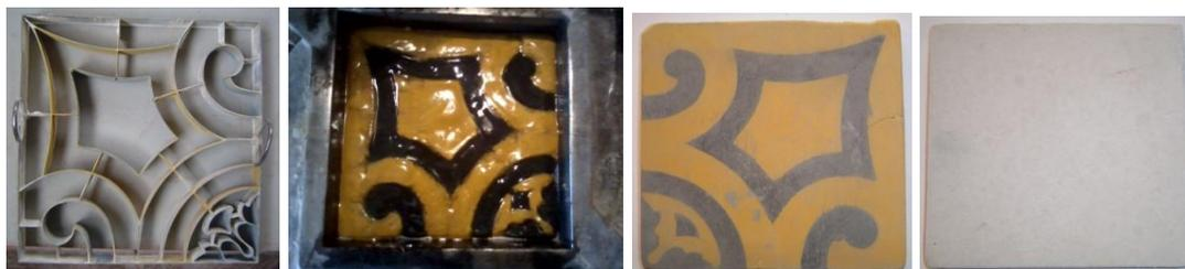
Figura 58 - Processo de fabricação ladrilhos testes – antes da queima
