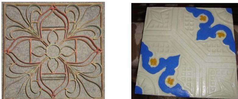
Figura 52 – Molde e LH. em execução na Fábrica de Mosaicos, Pelotas/RS
