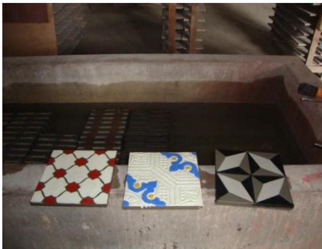
Figura 31 - LH em processo de cura.
