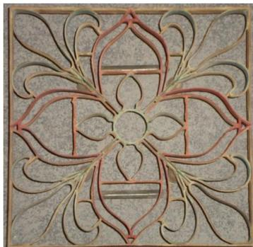
Figura 22 – Molde (matriz) de cobre da FM - Pelotas/RS
