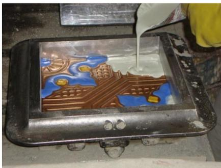
Fig. 23 – Colocação da primeira camada com pigmentos. FM - Peloras,RS
