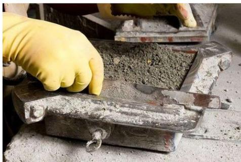
Figura. 25 - Colocação da terceira camada, composição úmida.
