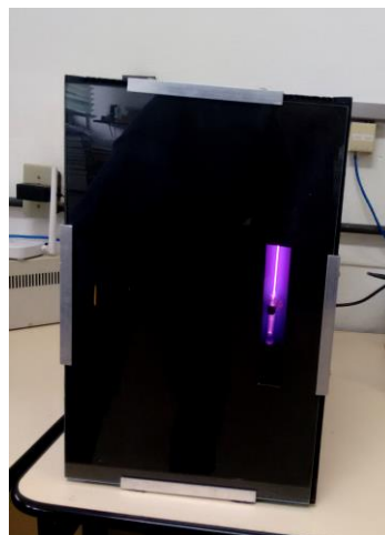
Figura 9 – Experimento da ionização de gases em tubo de Geissler
