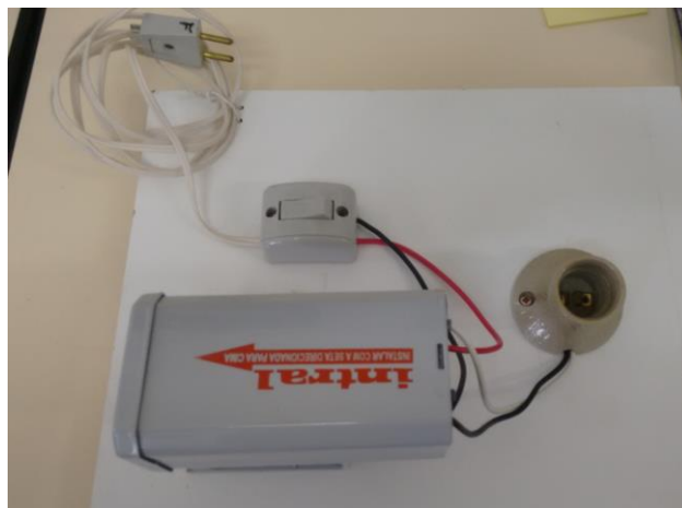
Figura 12 – Aparato para o estudo da lâmpada de vapor de sódio
