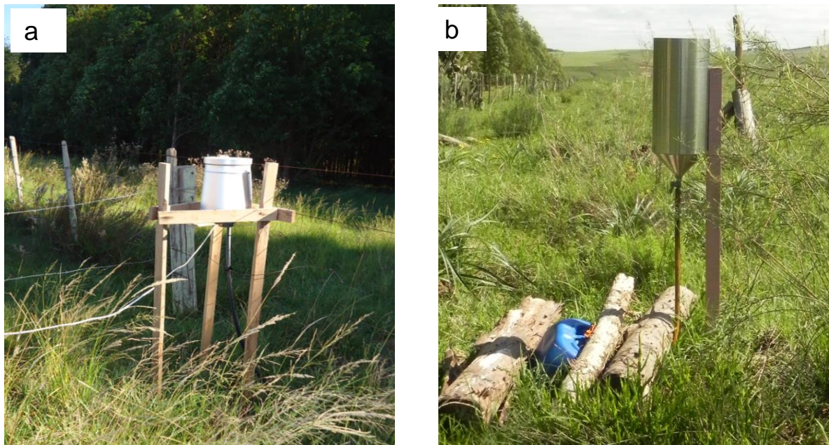
Figura 7 - a) Pluviômetro automático; b) Pluviômetro manual.
