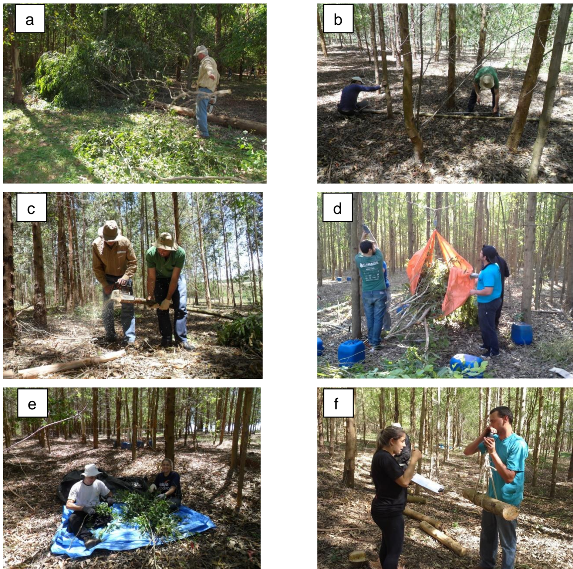
Figura 11 - a) Desgalhamento da árvore-amostra; b) Cubagem pelo método de Smalian; c) Separação do tronco em toretes; d) Separação dos galhos e folhas; e) Pesagem total dos galhos e folhas; f) Pesagem dos toretes.
