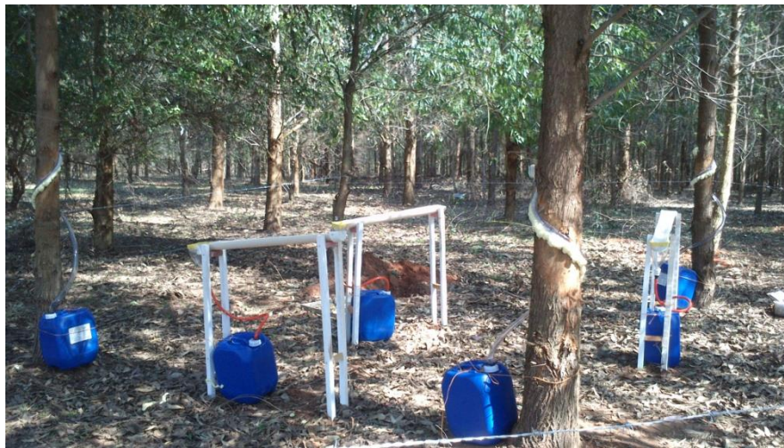
Figura 8 - Pluviômetros lineares distribuídos no interior do povoamento de Eucalyptus dunnii .
