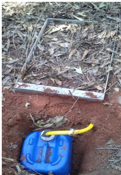
Figura 10 - Calha de coleta do escoamento superficial de água no solo.
