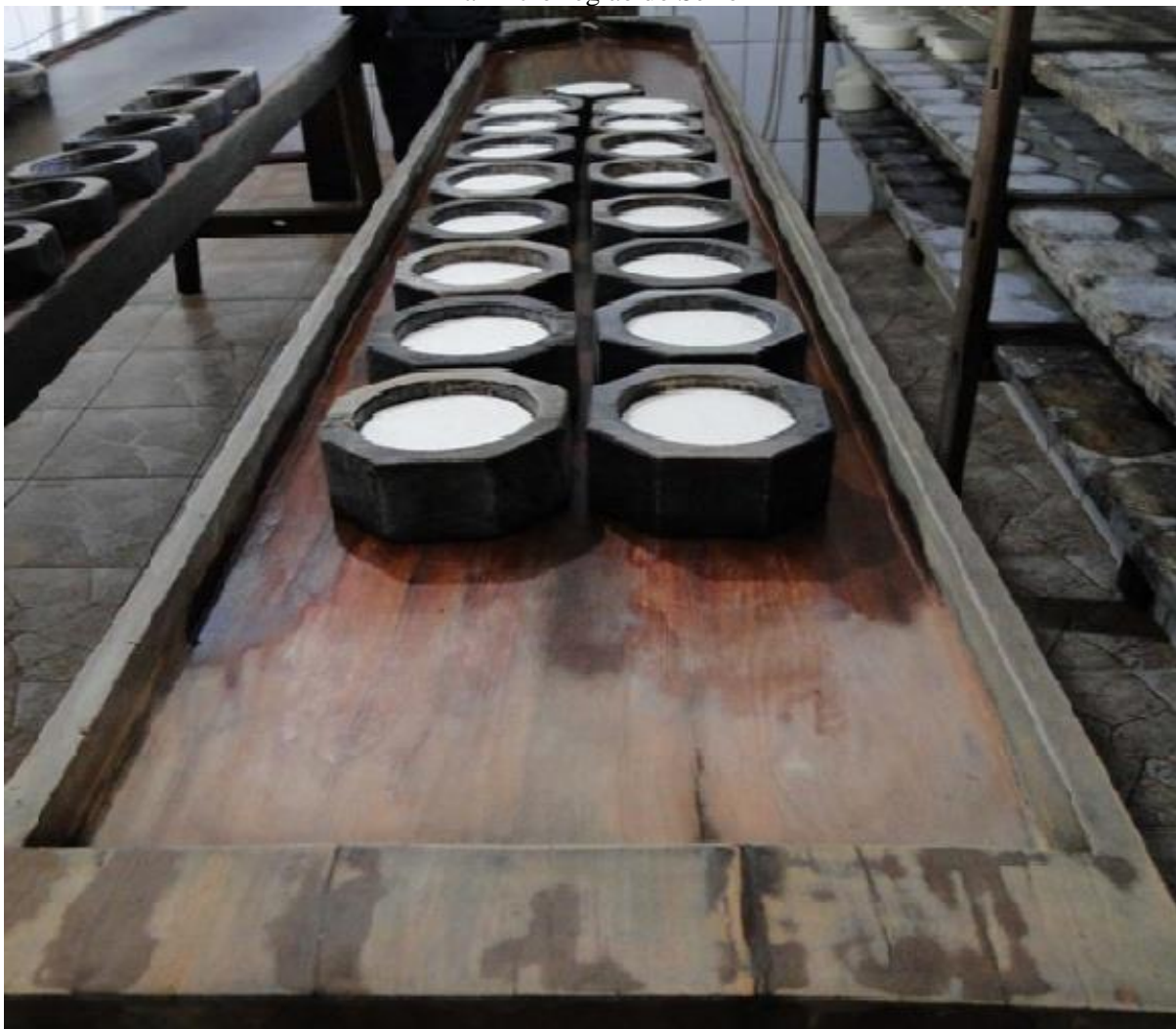
Figura 25 – Bancadas de manipulação/descanso, fôrmas e prateleiras de maturação feitos de madeira na Microrregião do Serro
