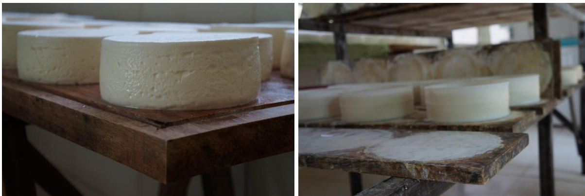
Figura 24 – Bancada de manipulação/descanso e prateleiras de maturação feitas de madeira
