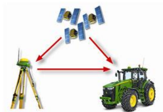
Figura 3 -: Funcionamento de um sistema RTK ( Real Time Kinematic ).
