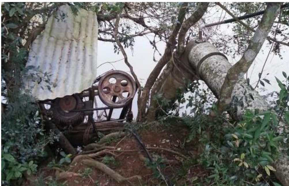
Figura 2.6 – Bomba de levante submersa com transmissão por correia e polias
