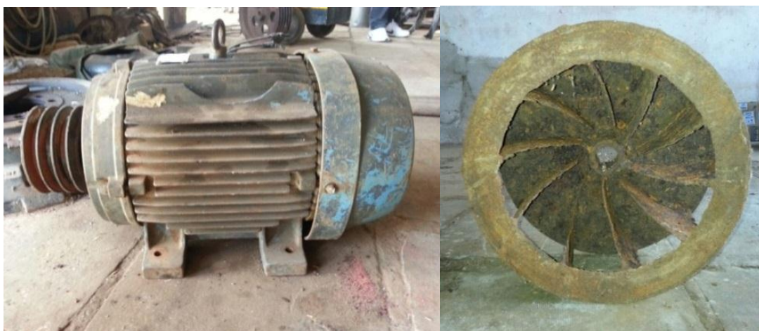
Figura 2.8 – (a) Motor e (b) rotor de bomba de levante, degradados pelo uso sem manutenção
