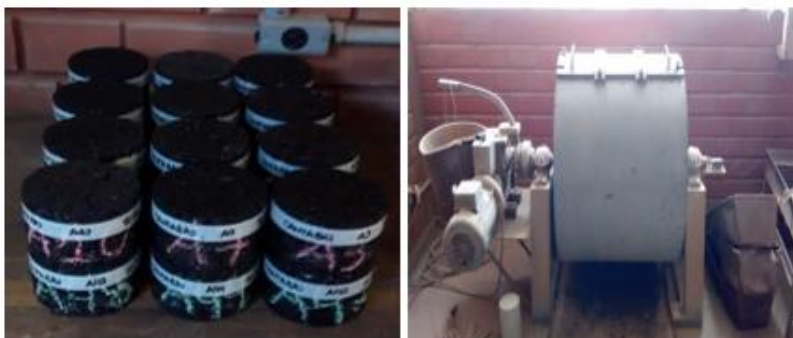
Figura 32 - Corpos-de-prova submetidos ao equipamento Abrasão Los Angeles, do LMCC, para realização do ensaio de Cântabro
