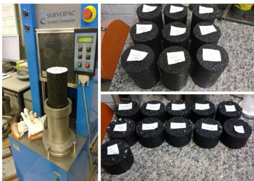
Figura 23 - Compactador Giratório Superpave, equipamento do laboratório LMCC, e amostras dos corpos-de-prova moldados para ensaio
