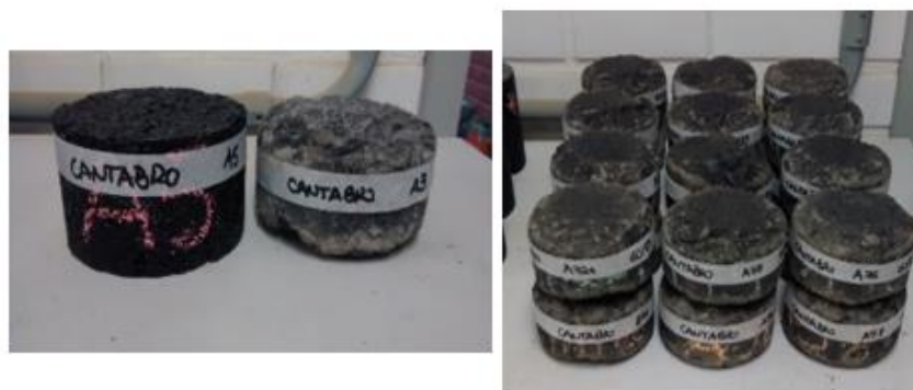
Figura 80 - Corpos-de-prova submetidos ao ensaio de desgaste por perda de massa Cântabro
