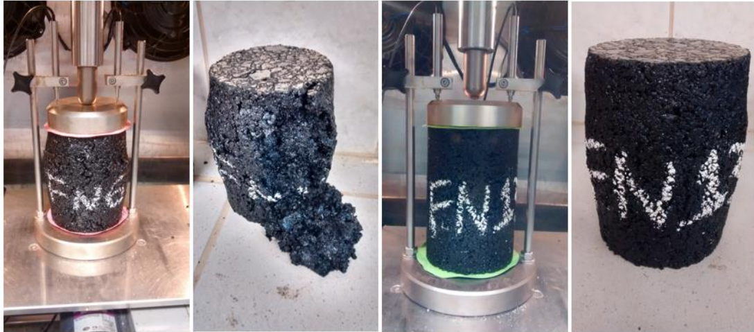
Figura 37 - Corpos-de-prova sendo ensaiados para determinação do Flow Number
