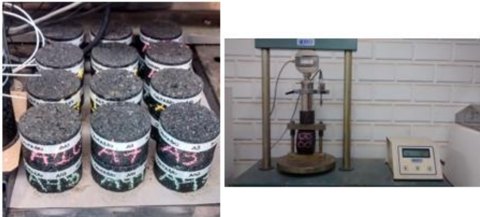
Figura 27 - Corpos-de-prova condicionados a 25°C e após ensaiados na prensa RT
