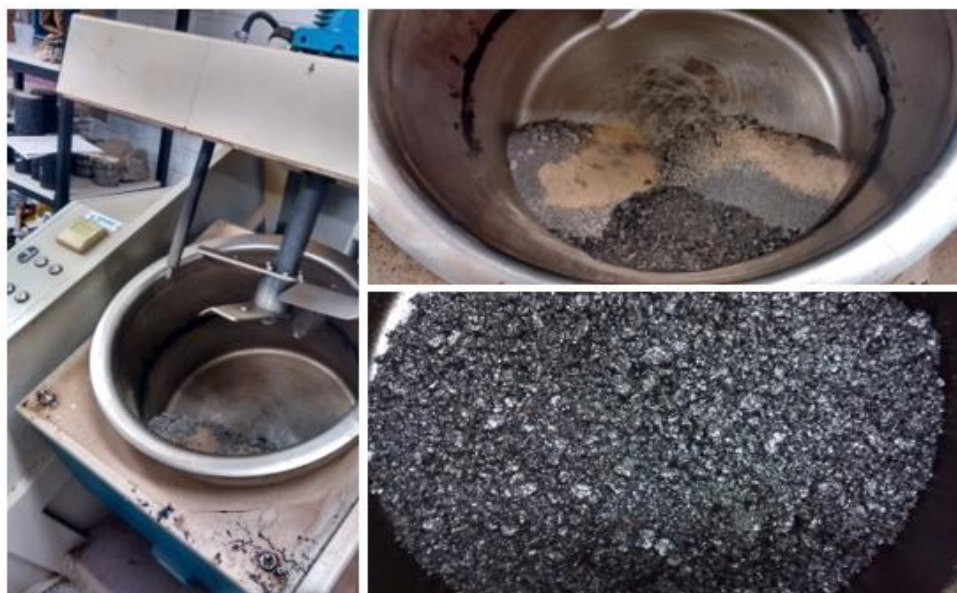
Figura 22 - Processo de usinagem das misturas asfálticas estudadas com o InfraTest
