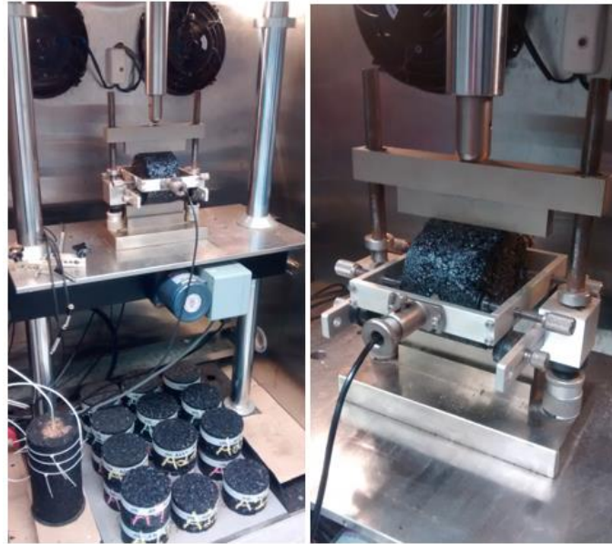
Figura 29 - Ensaio de MR realizado no equipamento UTM-25
