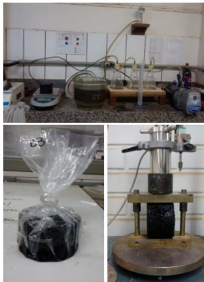
Figura 31 - Execução do ensaio de Lottman Modificado para o grupo de amostras condicionadas (primeiro grupo)
