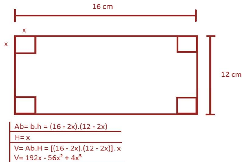
Para montar uma caixa a partir de uma cartolina retangular de medidas 16cm x 12cm são retirados quadrados de medida  $x$  a partir de cada um dos cantos da cartolina, com  $x$  maior que zero e menor que 6. Na notação de conjuntos,  $(0, 6)$  ou  $]0, 6[$ , com as unidades em centímetros. Após retirar esses quadrados do canto da cartolina, as abas restantes serão dobradas formando a altura da caixa. O valor restante dos lados da cartolina formará a base da caixa.
