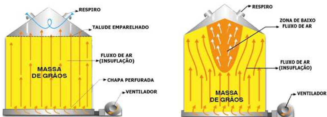
Figura 2 – Fluxo de ar na massa de grãos.
