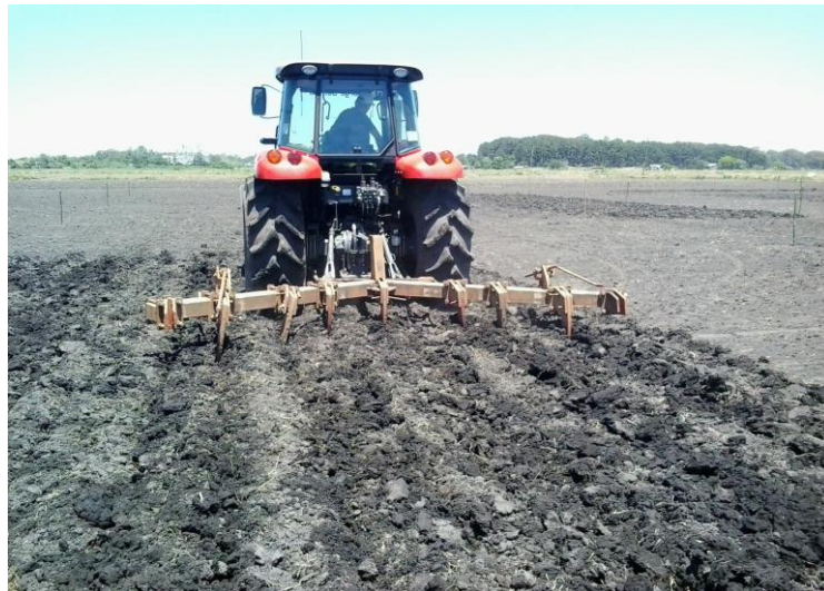
Figura 6. Escarificação realizada no ANO I. Conjunto Trator Massey Ferguson 7150 + Escarificador 9 hastes.
