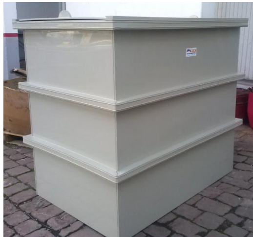
Figura 3.2.5 Acumulador de água do chiller
