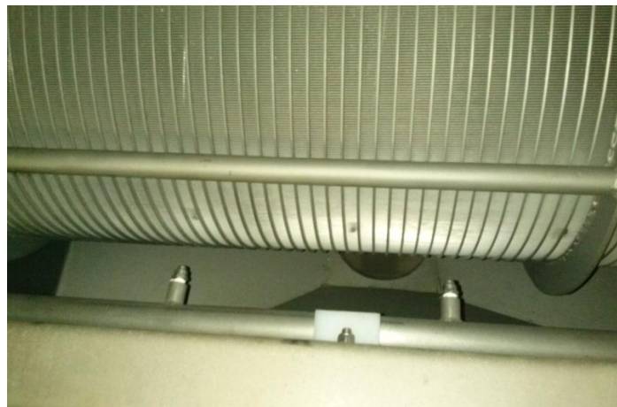
Figura 3.2.3 Sistema autolimpante da peneira rotativa.
