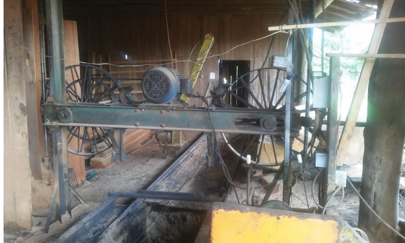
Figura 3.1 - Serra fita utilizada na serraria Dalcin Pasa.
