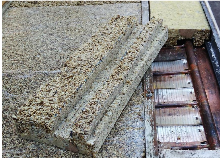
Figura 22 – Vista em detalhes dos recortes na placa isolante para adaptação no coletor solar
