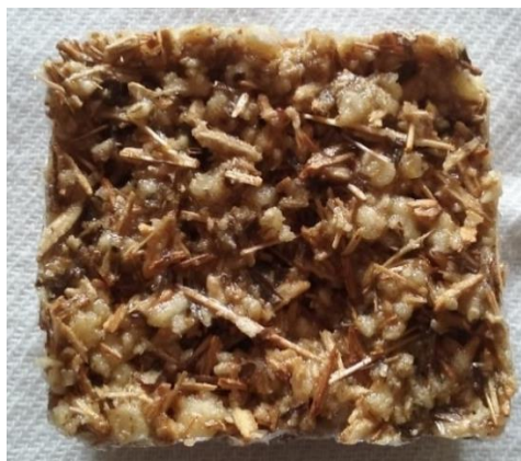
Figura 20 – Aparência do compósito desenvolvido
