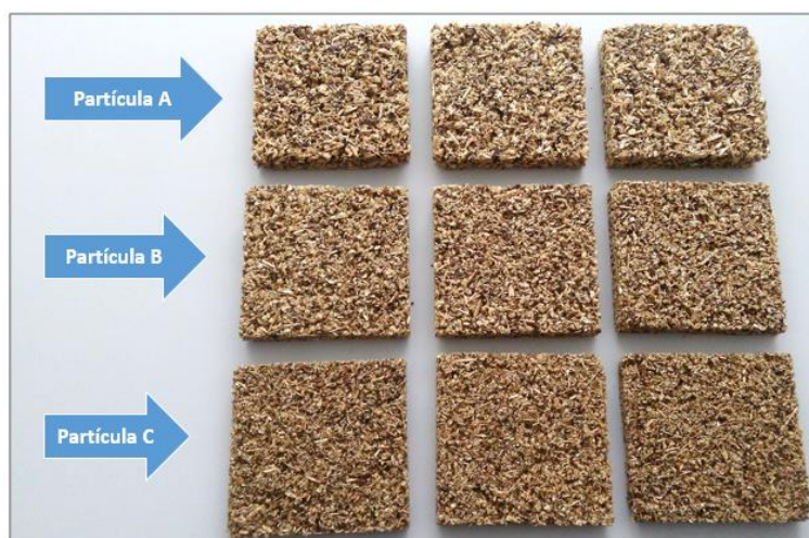
Figura 19 – Amostras elaboradas para determinação da condutividade térmica usando três tamanhos de partículas de talos de girassol
