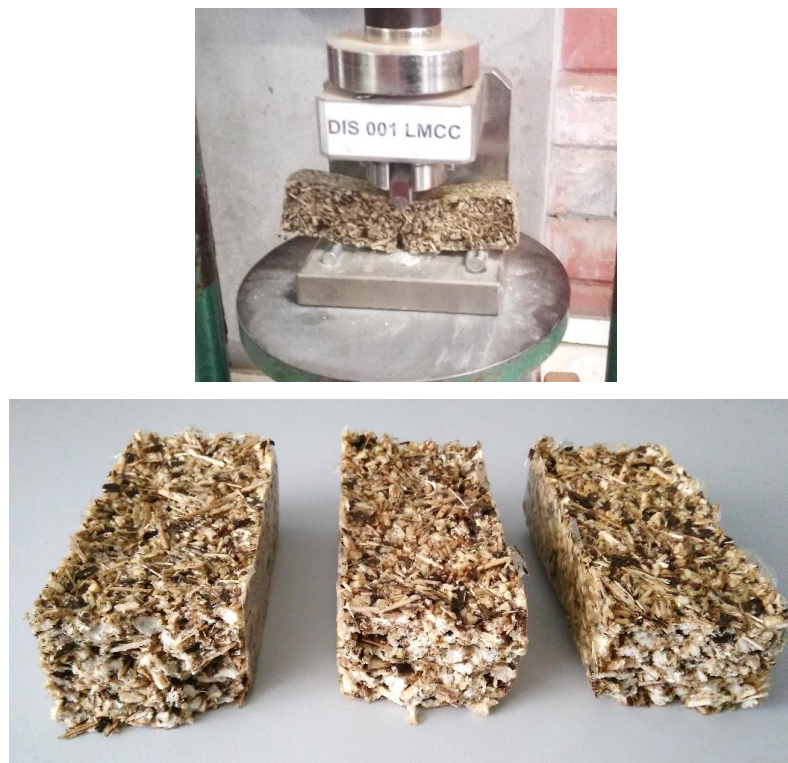
Figura 21 – Momento do teste de flexão e seção transversal das três amostras após fratura no teste
