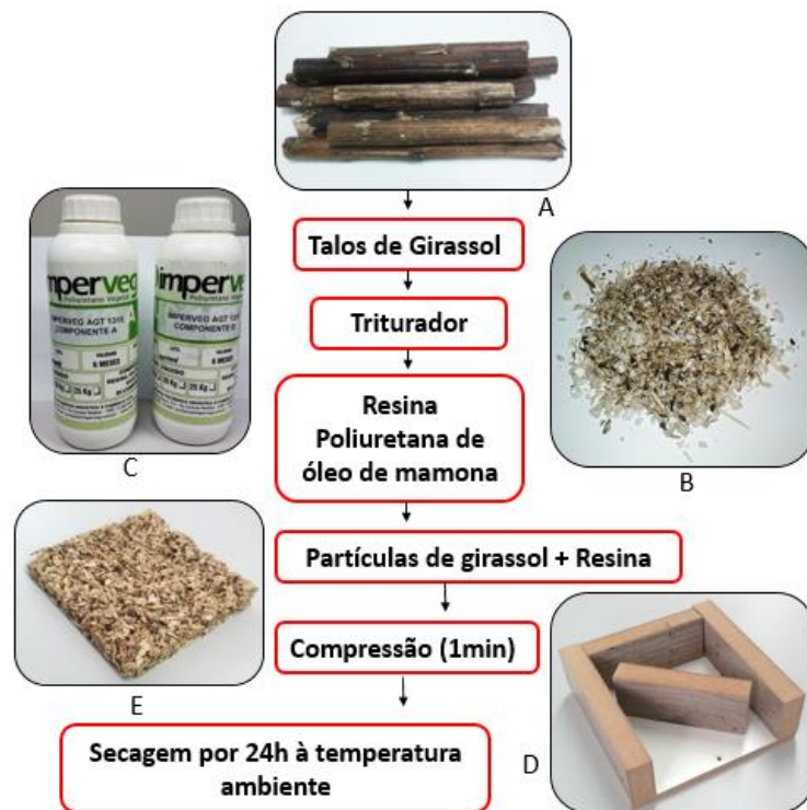
Figura 12 – Processo de fabricação do compósito de talos de girassol desenvolvido na pesquisa
