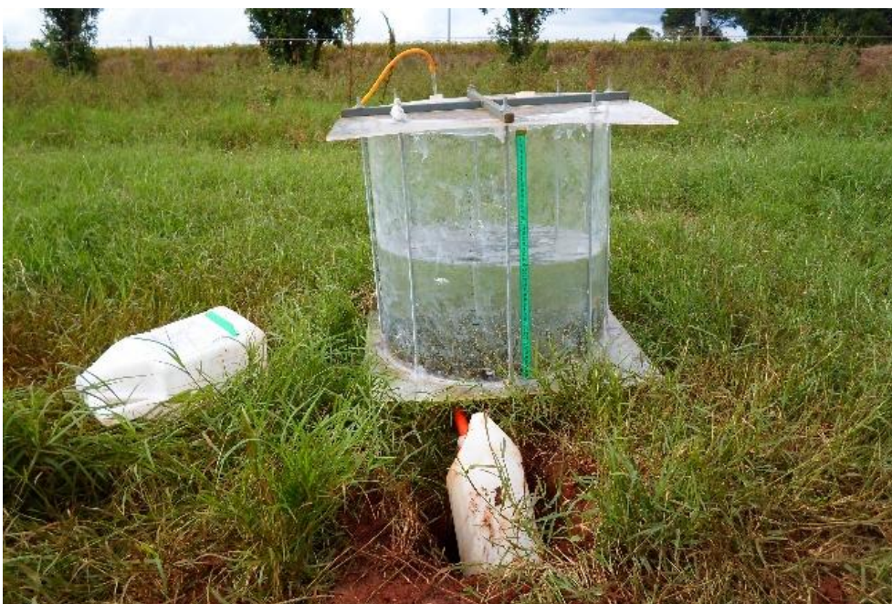
Figura 6 – Infiltrômetro de Cornell utilizado para determinação da taxa de Infiltração de água no solo.
