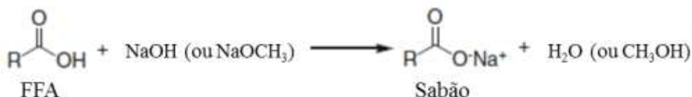
Figura 8 - Reação de saponificação entre um FFA e catalisador básico.
