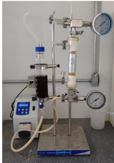
Figura 4- Processo de separação por membranas – Microfiltração.
