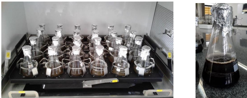
Figura 3- Aspecto do pré-inóculo aos 7 dias após a fermentação.
