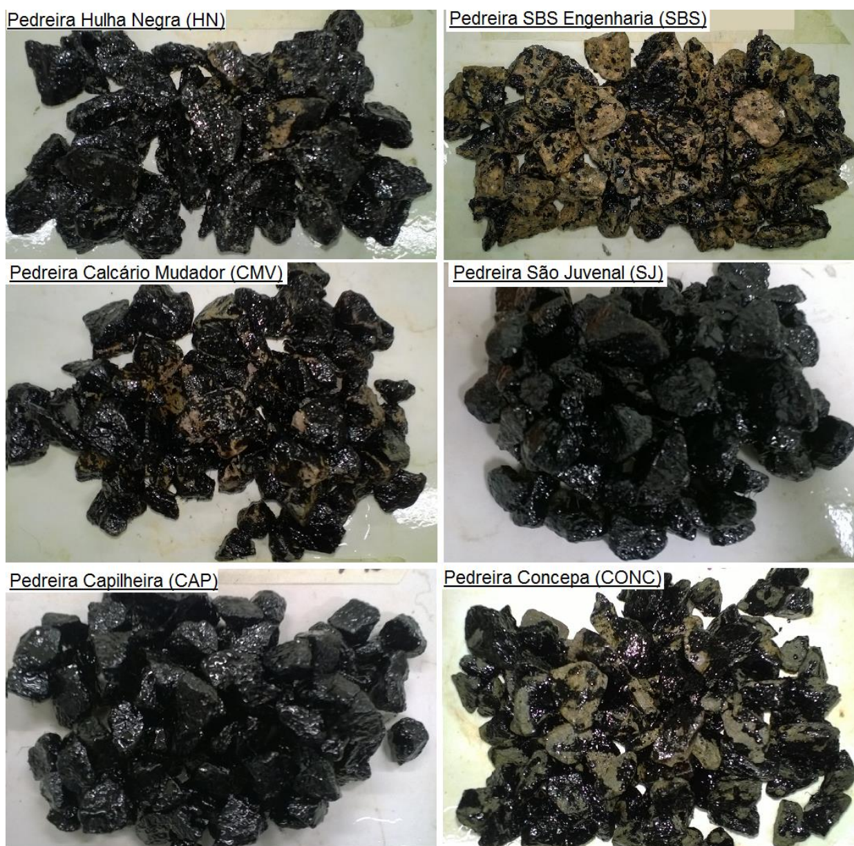
Figura 4.2.18 - Agregados após ensaio de adesividade.
