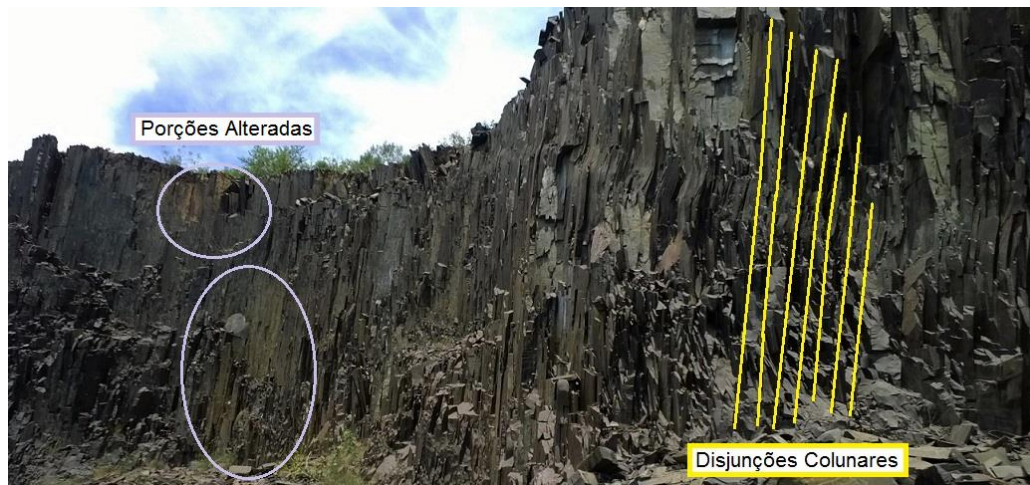
Figura 4.1.21 - Parede rochosa da Pedreira CONC com disjunções colunares.
