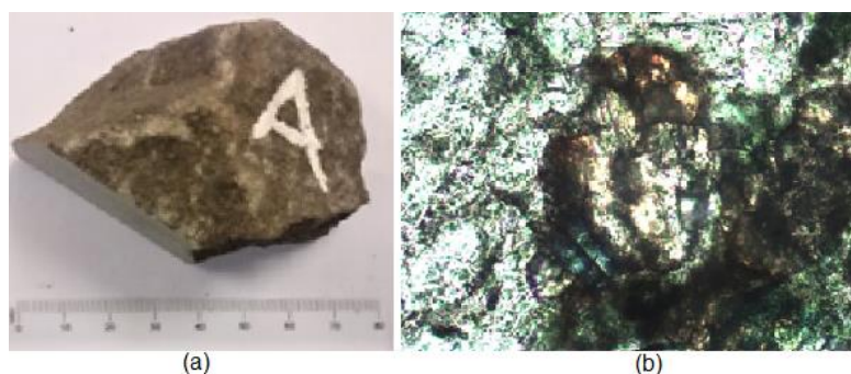
Figura 4.1.18 - Detalhes da rocha SJ - AMOSTRA 1 (a) Amostra de mão; (b) Vista em microscópio petrográfico com destaque para cristal de olivina (aumento 2,5/0.08).
