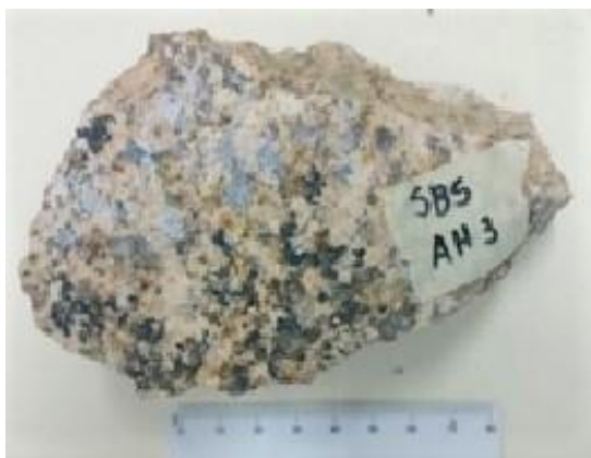
Figura 4.1.13 - Detalhes da textura da rocha da Pedreira SBS - AMOSTRA 3.
