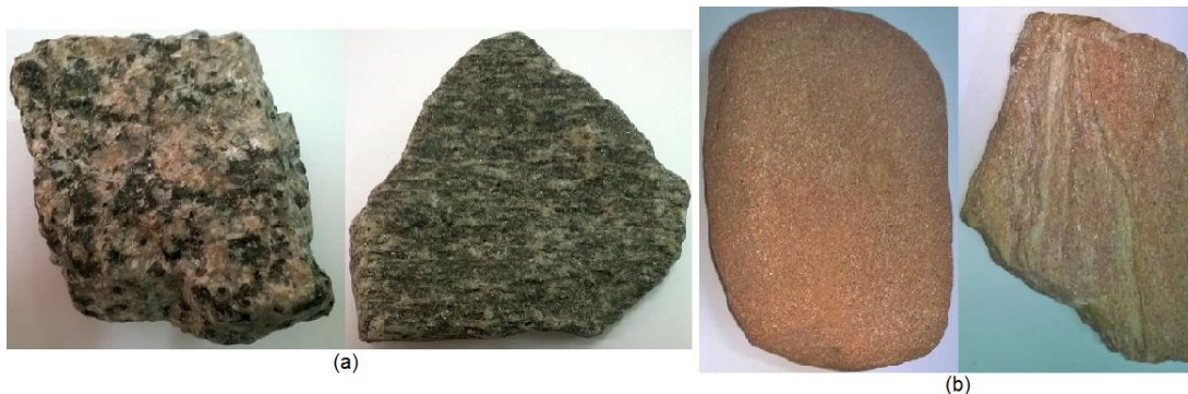
Figura 2.2.3 - Granito (ígneia plutônica) quando metamorfozizada dá origem ao Gnaiss; (b) Arenito (sedimentar) quando metamorfozizada dá origem aos Quartzito.
