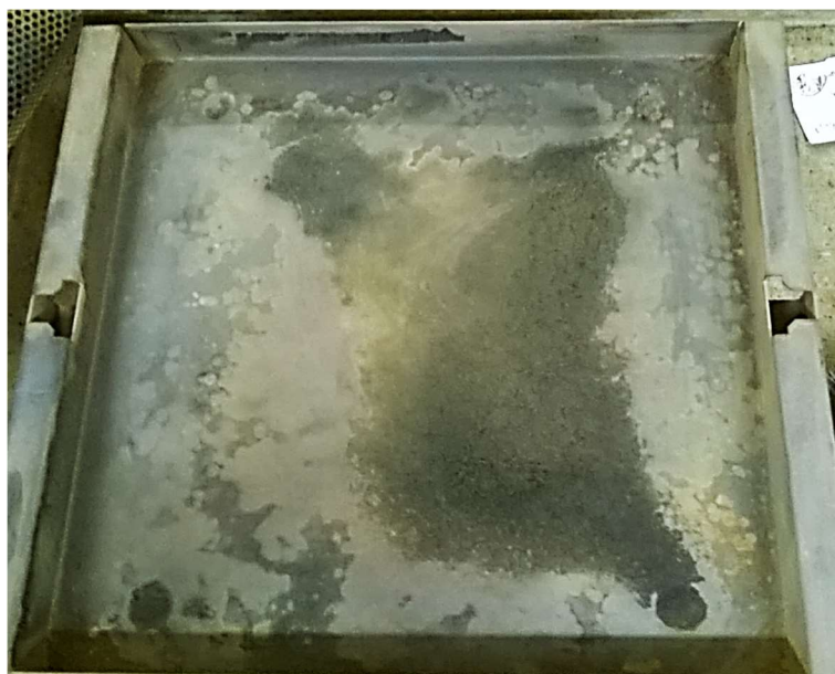
Figura 3.101 – Ligante não queimado no ensaio de extração - forno de ignição
