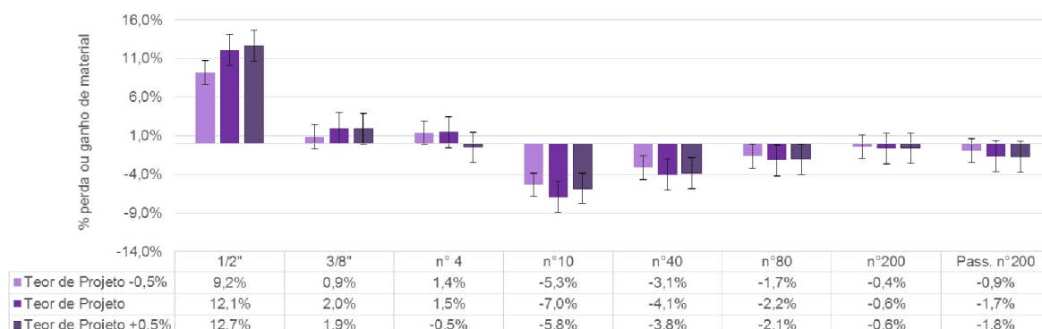
Figura 3.100 - Diferenças médias de material retidos por peneira – centrífuga - Faixa C
