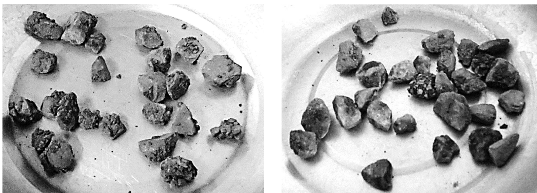
Figura 3.26 – Exemplos de material acumulado na peneira 3/8” de diferentes amostras - centrífuga
