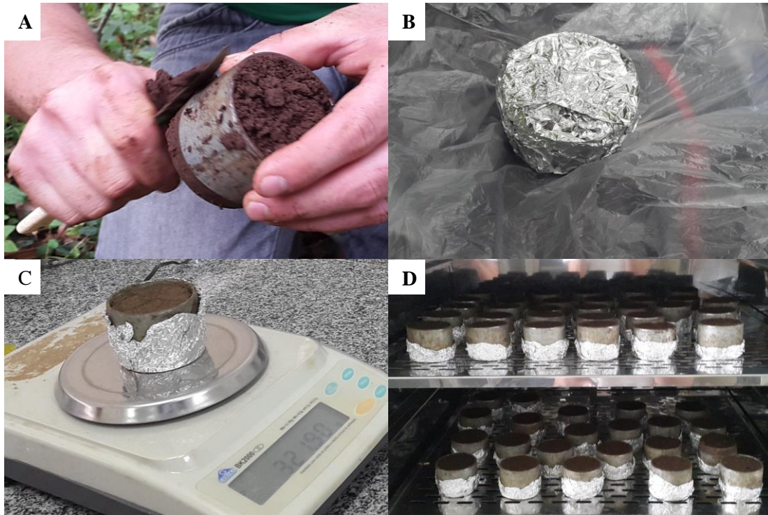
Figura 9 – Coleta do solo para teste de umidade: (A) e (B) coleta e preparo do solo para ser transportado até o laboratório. (C) e (D) Procedimentos de pesagem e de secagem do solo para posterior determinação da umidade do solo. Sant’Ana do Livramento/RS e Alegrete/RS. 2017.
