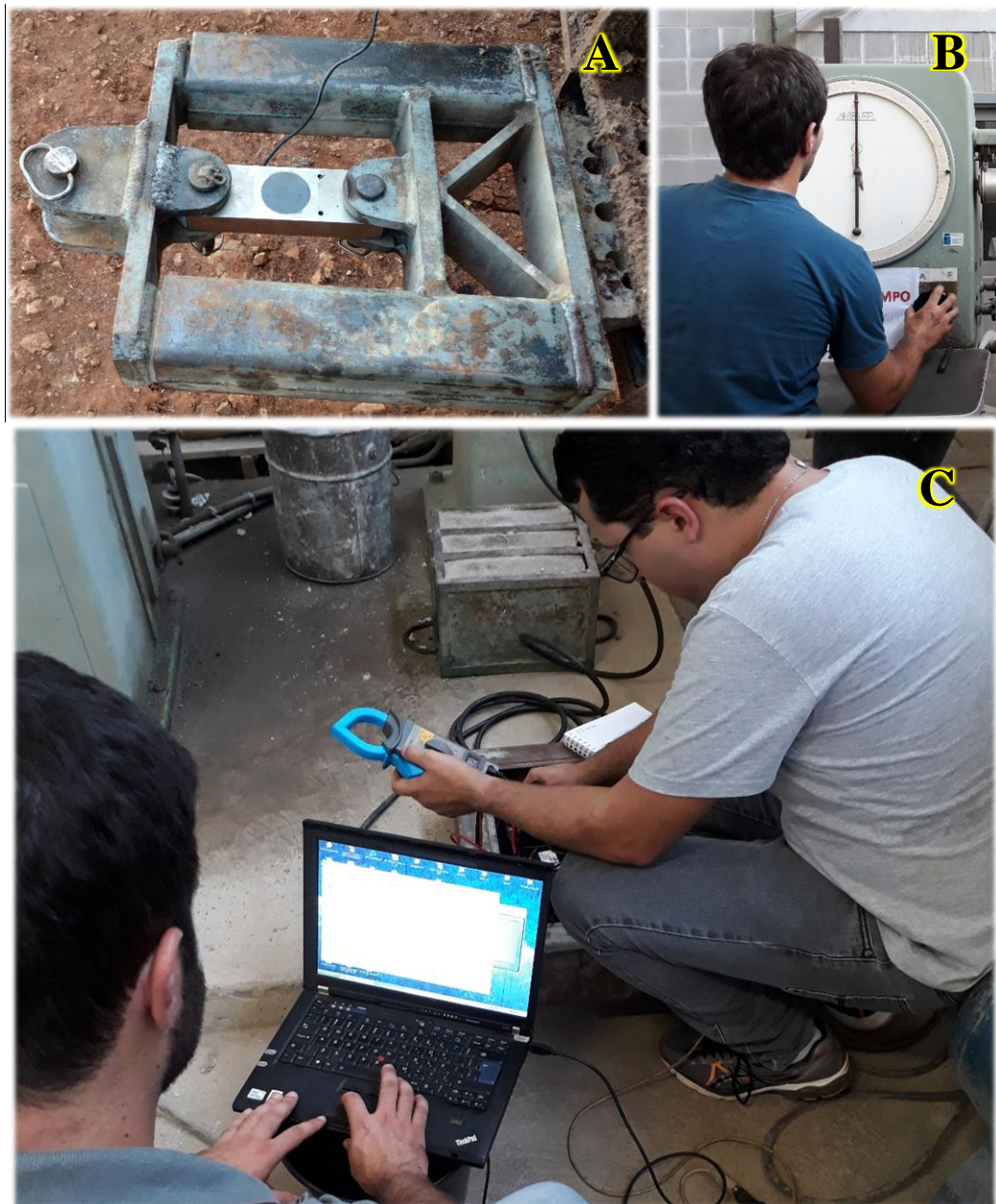
Figura 15 - Célula de carga (A), equipamento Amsler para imposição de cargas (B) e aferição dos valores coletados no datalogger e voltímetro (C).
