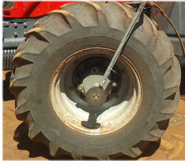
Figura 16 - Sensores indutivos nas rodas motrizes para medida do patinamento
