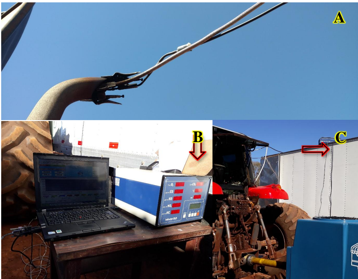
Figura 22 - Coleta dos gases no escapamento do motor do trator (A), analisador de gases (B) e analisador de opacidade (C)
