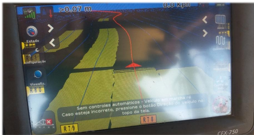
Figura 10 - Monitor do trator utilizado no experimento demonstrando a operação no modo piloto automático sobre as linhas de tráfego definidas.
