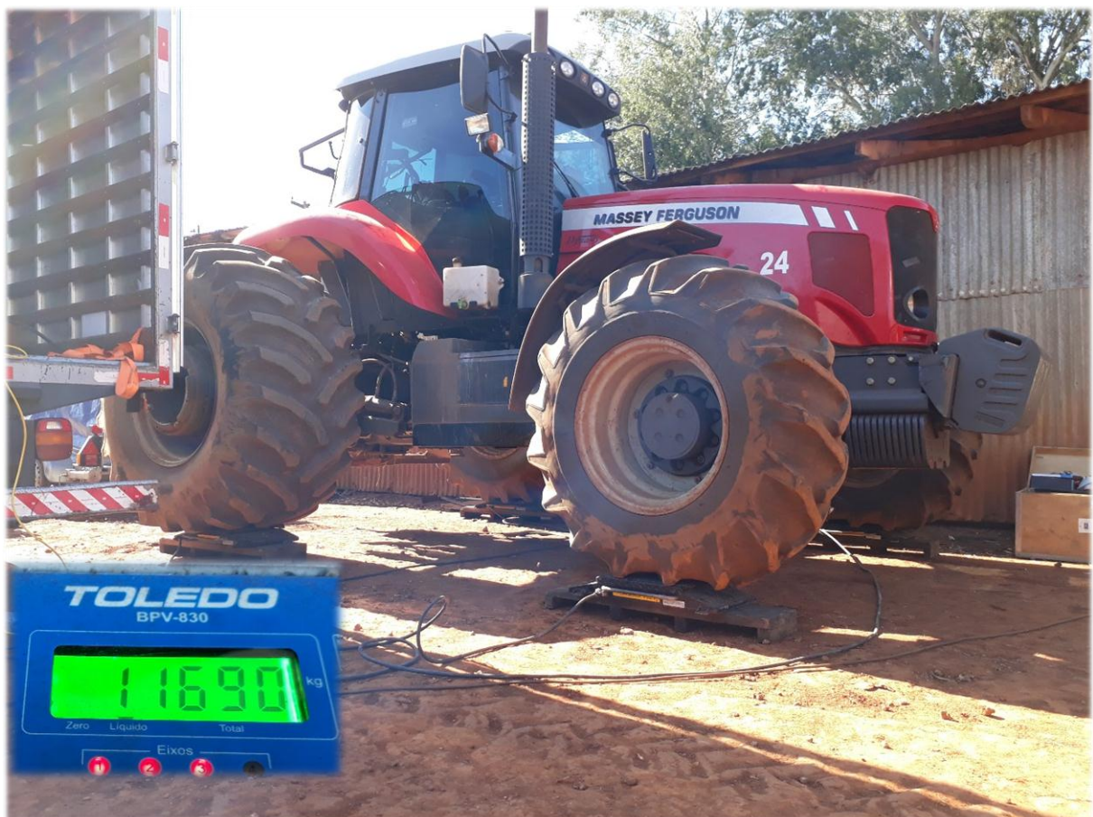
Figura 7 - Medida da massa total do trator com a utilização de balança digital portátil.
