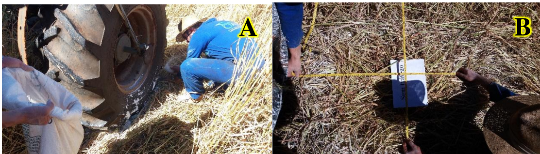
Figura 20 - Demarcação da área de contato dos pneus dianteiros e traseiros (A) e obtenção das medidas (B)
