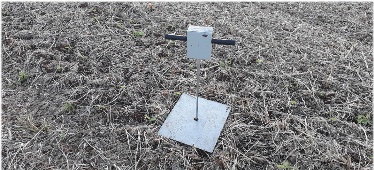
Figura 21 - Avaliação da resistência a penetração com o uso de penetrômetro
