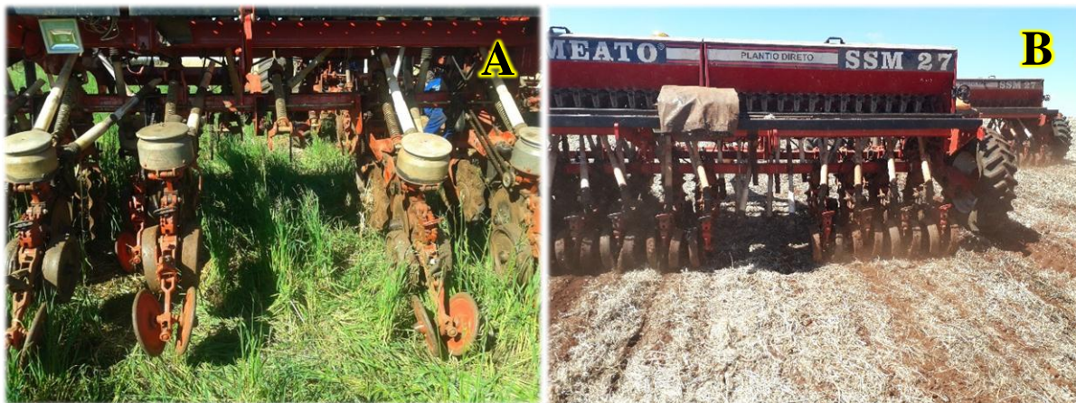
Figura 11 - Semeadora com a configuração de sulcadores disco duplo sem haste (DDsH) nas linhas que recebem o tráfego de máquinas no primeiro (A) e segundo (B) experimento
