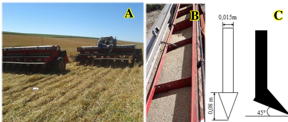
Figura 8 - Conjunto de semeadoras da marca Semeato, modelo SSM 27 em sistema de tandem, utilizadas no experimento (A), lastragem da semeadora com uso de fertilizante (B).
