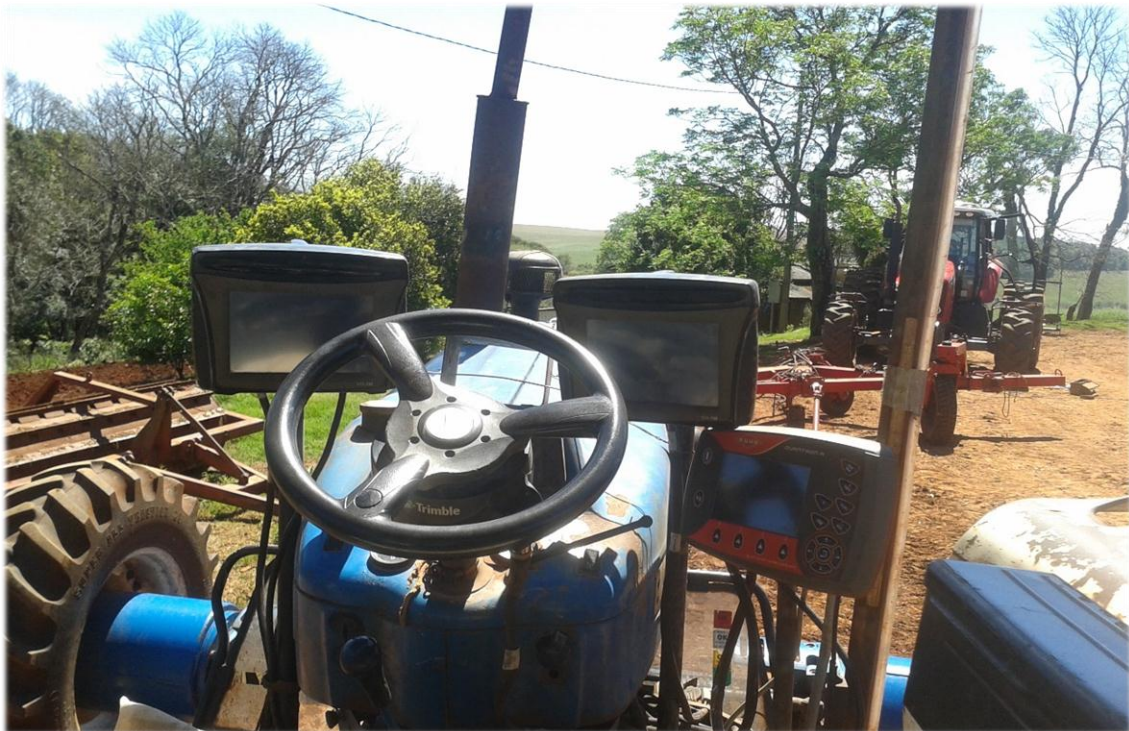
Figura 5 - Trator Ford 8030 utilizado para distribuição de fertilizantes, equipado com receptor DGPS, piloto automático e monitores para o acompanhamento das operações
