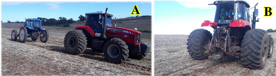
Figura 17 - Determinação da resistência ao rolamento com a utilização de outro trator para tracionar o trator teste (A) acoplado a célula de carga (B).
