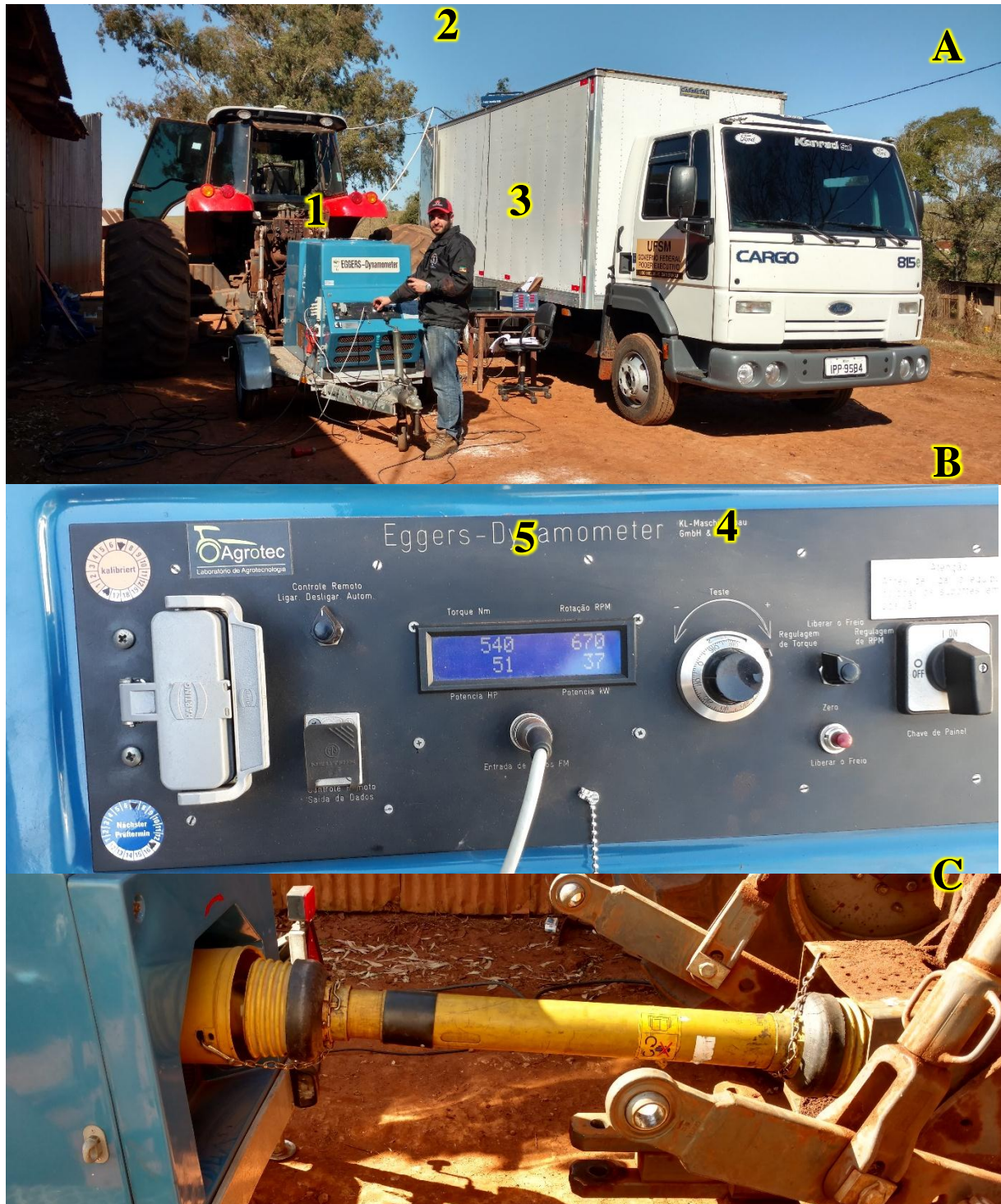
Figura 24 - Organização dos equipamentos utilizados na avaliação da emissão dos gases (A) com dinamômetro (1), opacímetro (2), Infrality (3) com as cargas inseridas no controlador de cargas (4) e visualizadas no visor digital (5) do painel de controle do dinamômetro (B) acoplado ao trator pela TDP (C)
