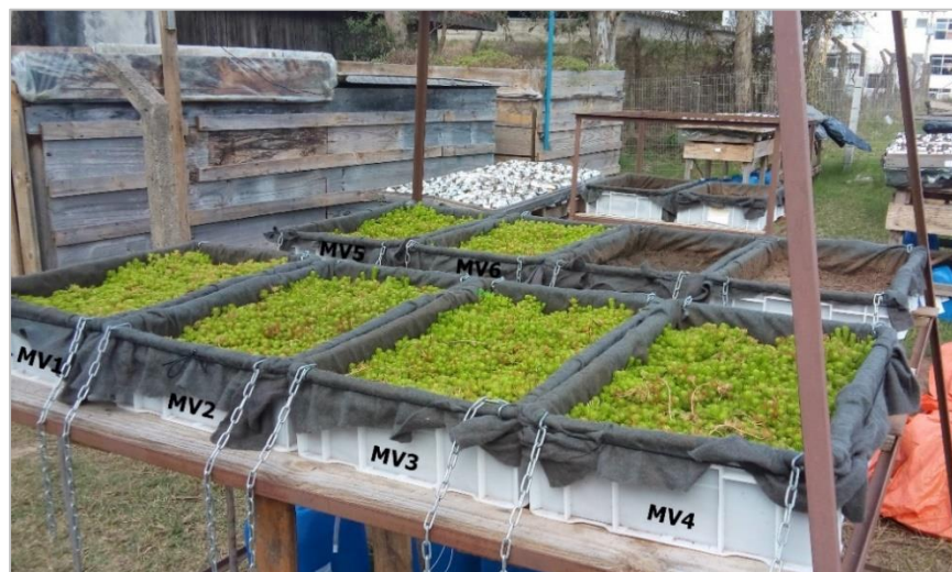
Figura 17 - Módulos experimentais de telhados verdes extensivos instalados.
