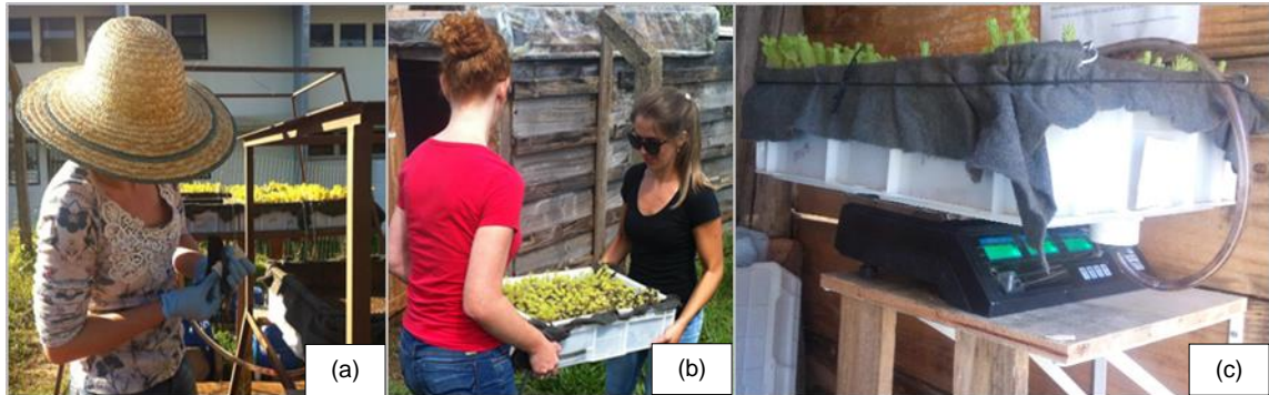
Figura 8 - Rotina de pesagem dos módulos. (a) retirada dos drenos das bombonas e vedação do orifício de saída da mangueira. (b) transporte dos módulos até a balança. (c) pesagem dos módulos.
