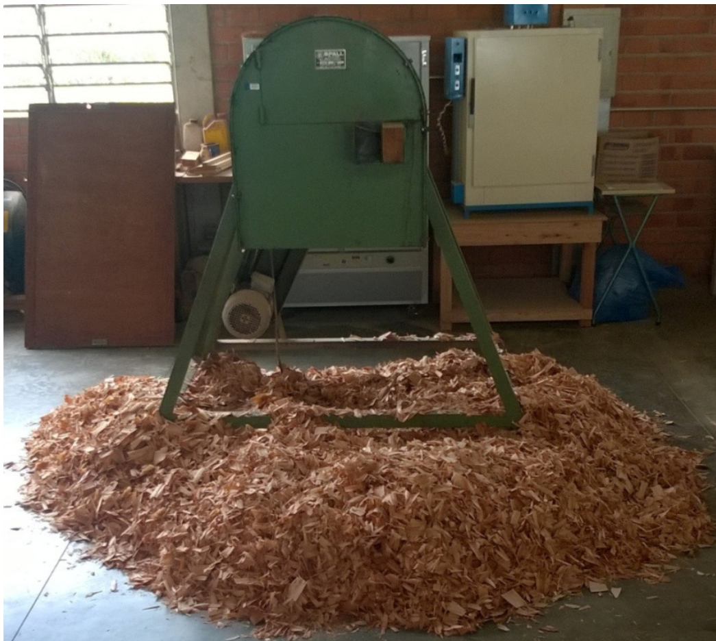
Figura 2.3 - Equipamento do tipo Flaker e lascas produzidas a partir dos discos de cinamomo.
