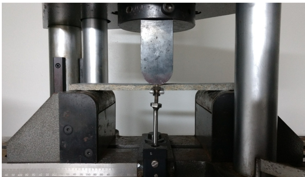
Figura 5.2 - Ensaio de flexão estática.
