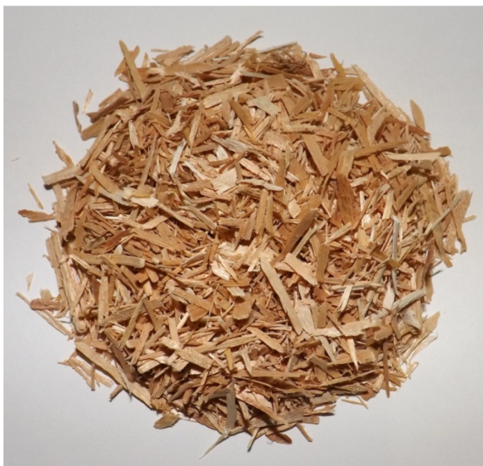
Figura 2.4 - Partículas após processamento em moinho de martelos e classificação.
