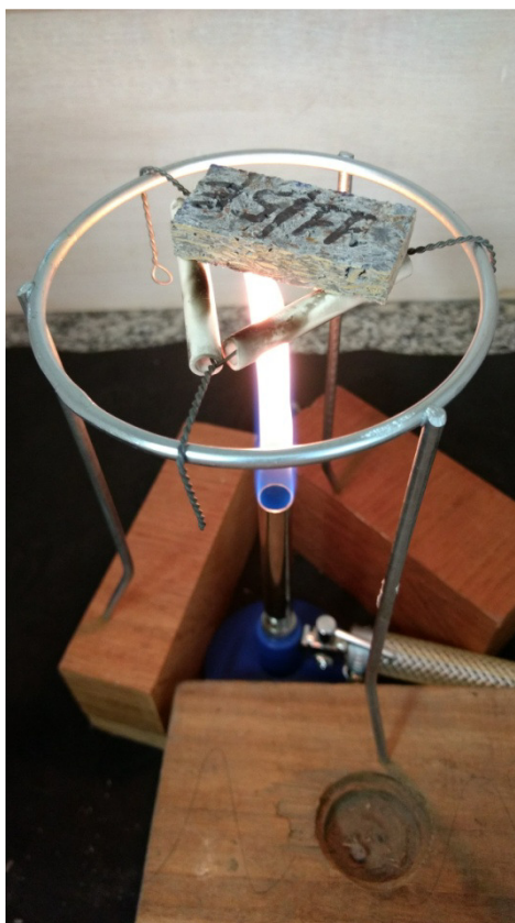
Figura 4.1 - Ensaio de resistência ao fogo.
