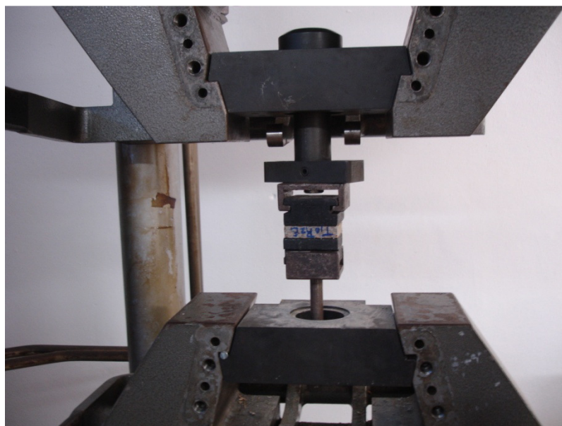
Figura 5.4 - Ensaio de tração perpendicular à superfície do painel.
