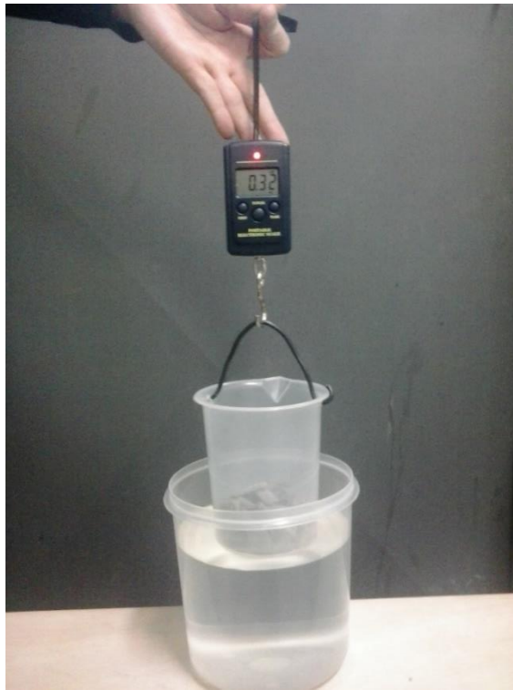
Figura 19 – Esquema da montagem do experimento sobre Arquimedes
