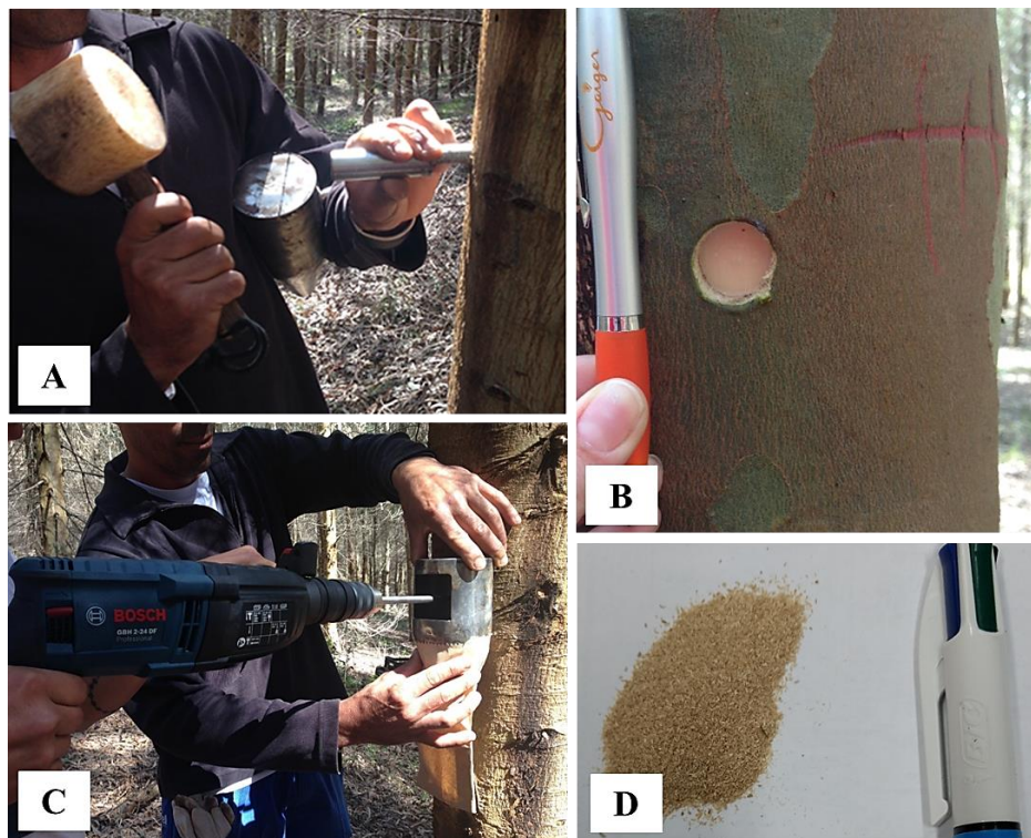
Figura 1 – Processo de amostragem inicial das árvores no povoamento. A e B) Remoção da casca na altura do DAP. C) Coleta da serragem com furadeira e broca de tamanho 3/8. D) Serragem obtida após processamento em moinho Willye
