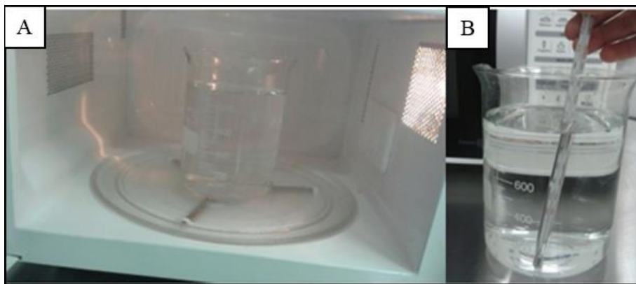
Figura 5 – Procedimento de determinação da potência real do micro-ondas. (A) 1000 mL de água ultrapura na cavidade de radiação micro-ondas. (B) Verificação da variação da temperatura ( \Delta T ).
