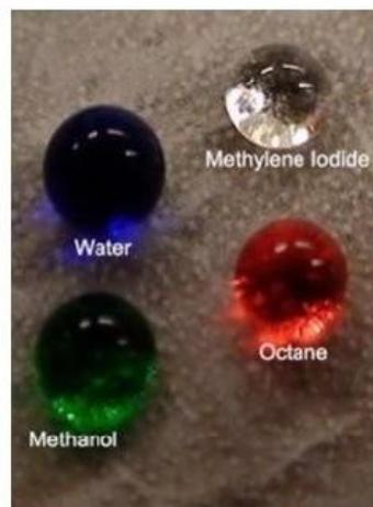
Figura 2.12 - Folha de Lótus revestida por fibras, formada a partir da mistura de um polímero hidrofílico (polimetilmetacrilato ou PMMA) e o fluoro POSS (Silsesquioxano poliédrico oligomérico): água ( $\gamma = 72,1 \text{ mN/m}$ ), iodeto de metileno ( $\gamma = 50,1 \text{ mN/m}$ ), metanol ( $\gamma = 22,7 \text{ mN/m}$ ) e octano ( $\gamma = 21,7 \text{ mN/m}$ ).
