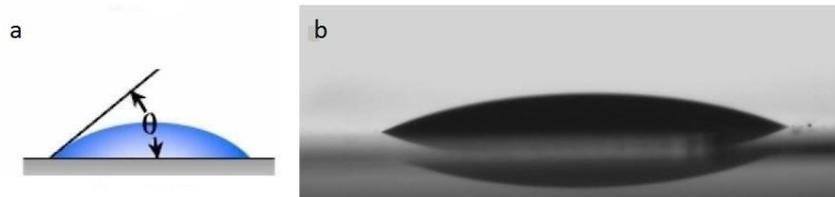
Figura 2.6 - (a) e (b)- Líquido em contato com uma superfície hidrofílica, formando um ângulo de contato inferior à  $90^\circ$ . (b) Gota de água sobre uma superfície de vidro.
