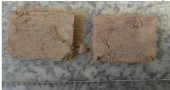
(c) Amostra com 191 raízes no corpo de prova: 45 raízes na superfície de ruptura (RAR correspondente na superfície de ruptura = 0,24%)
