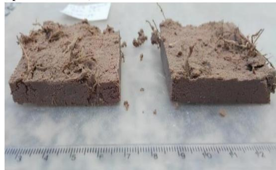
(c) Amostra com 191 raízes no corpo de prova: 60 raízes na superfície de ruptura (RAR correspondente na superfície de ruptura = 0,31%)
