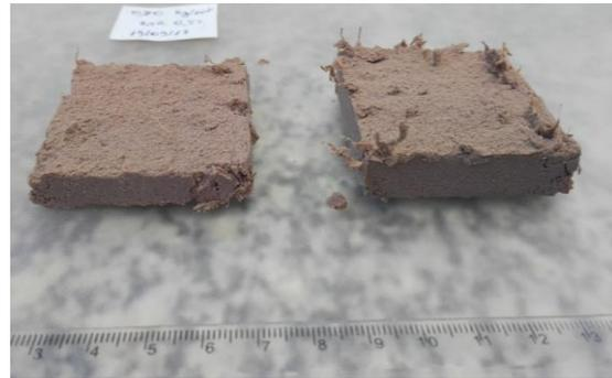
(a) Amostra com 64 raízes no corpo de prova: 19 raízes na superfície de ruptura (RAR correspondente na superfície de ruptura = 0,15%)
