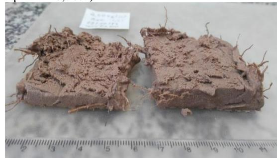
(c) Amostra com 191 raízes no corpo de prova: 61 raízes na superfície de ruptura (RAR correspondente na superfície de ruptura = 0,32%)
