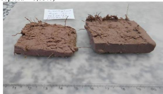
(b) Amostra com 127 raízes no corpo de prova: 38 raízes na superfície de ruptura (RAR correspondente na superfície de ruptura = 0,30%)
