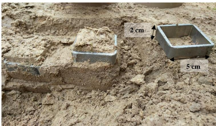
(c) Coleta do solo utilizando os anéis de cisalhamento direto
