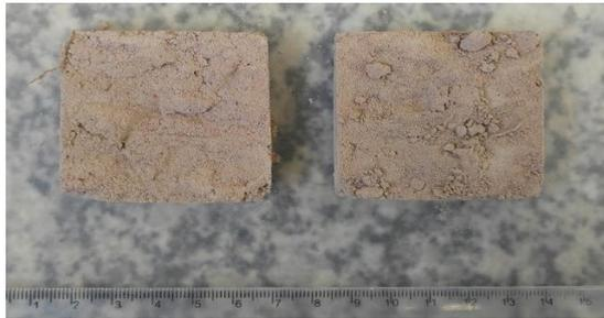
(a) Amostra com 64 raízes no corpo de prova: 12 raízes na superfície de ruptura (RAR correspondente na superfície de ruptura = 0,09%)
