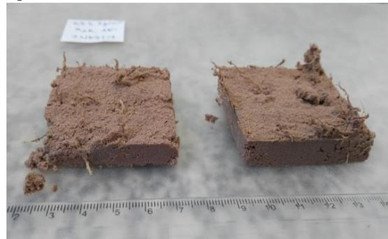
(b) Amostra com 127 raízes no corpo de prova: 43 raízes na superfície de ruptura (RAR correspondente na superfície de ruptura = 0,34%)
