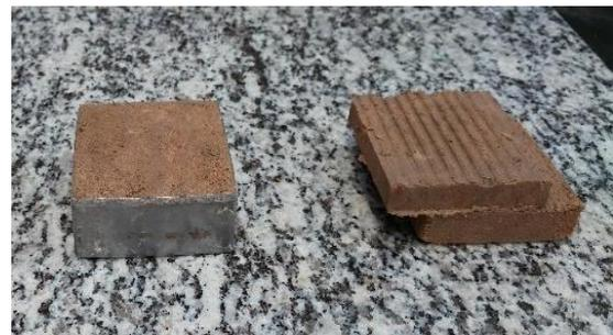
(i) Corpo de prova reconstituído antes (esquerda) e após a realização do ensaio de cisalhamento direto (direita).
