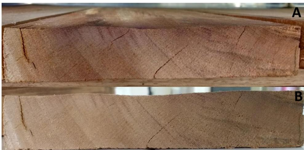
De acordo com Klitzke (2005), uma madeira na qual as fibras são paralelas ao eixo de orientação ou paralelas ao eixo longitudinal da peça serrada é considerada de grã reta, e seu comportamento, durante a secagem, auxilia significativamente na
