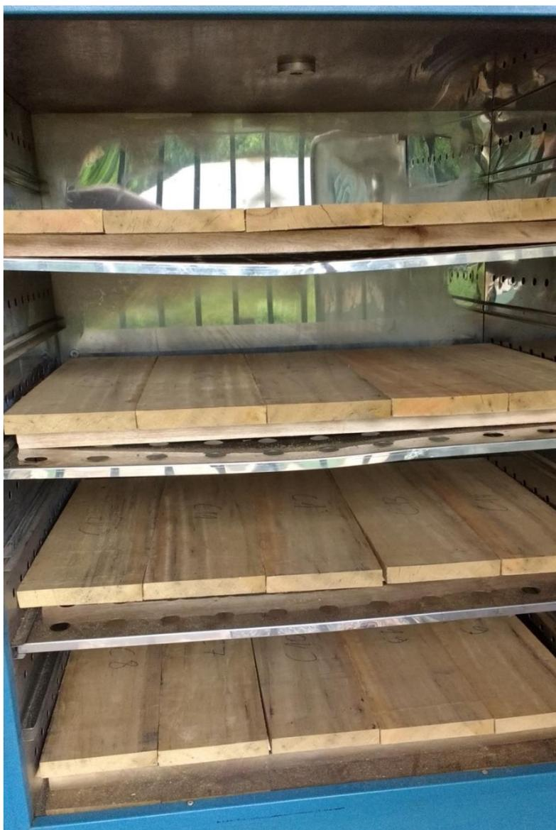
Durante a secagem, as amostras foram pesadas periodicamente para, posteriormente, elaborar a curva de secagem. O intervalo entre as medições foi de três horas no início do ensaio e mais de 30 horas ao final do mesmo, visto que a variação no teor de umidade de algumas espécies, neste estágio, era de menos de 1% a cada 24 horas. Essa variação no tempo entre as medições se deve a maior perda de massa de água no início da secagem em relação ao final do processo.
