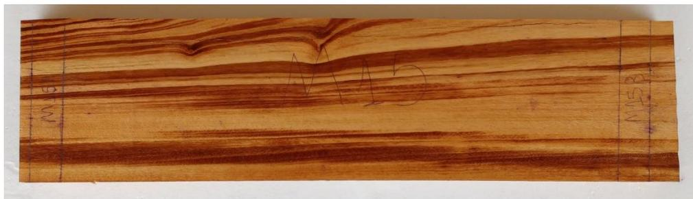
As amostras tiveram suas dimensões e sua massa mensuradas antes do início da secagem, além da verificação de qualquer tipo de defeito, como empenamentos e rachaduras. Em seguida, as mesmas foram submetidas à secagem em estufa de circulação de ar, com temperatura constante de 60°C.
