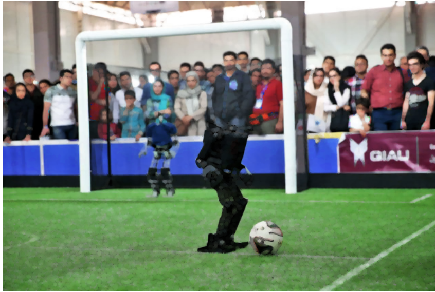
Figura 5.5 – Operação morfológica de abertura em uma imagem do campo de futebol de robôs com valor do kernel igual a 5
