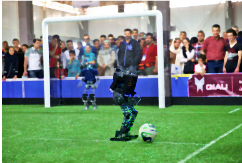
Figura 5.6 – Operação morfológica de fechamento em uma imagem do campo de futebol de robôs com valor do kernel igual a 5
