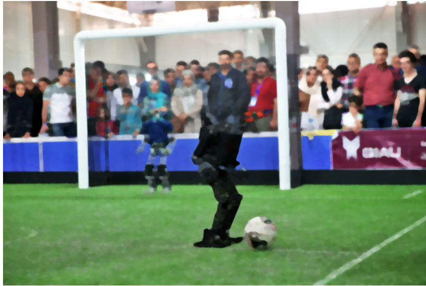
Figura 5.7 – Operações morfológicas de abertura e fechamento em uma imagem do campo de futebol de robôs com valor de kernel igual a 5
