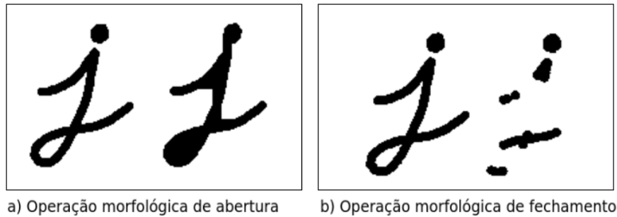
Figura 3.8 – Operações morfológicas de (a) abertura e (b) fechamento (OPENCV, 2016)
