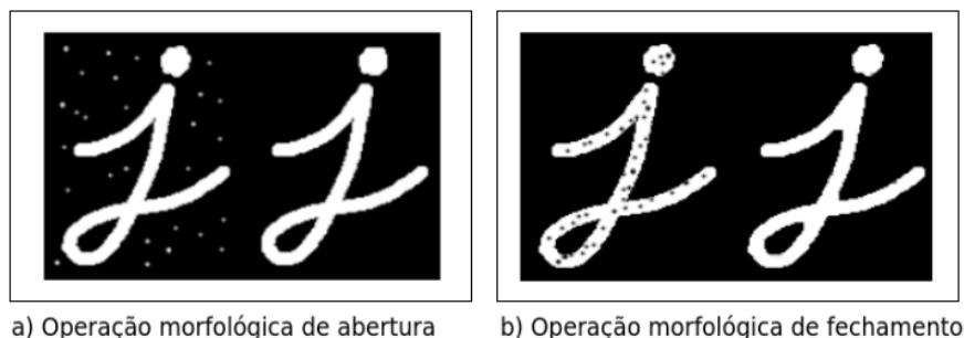
Figura 3.9 – Operações morfológicas de (a) abertura e (b) fechamento com kernel reduzido
