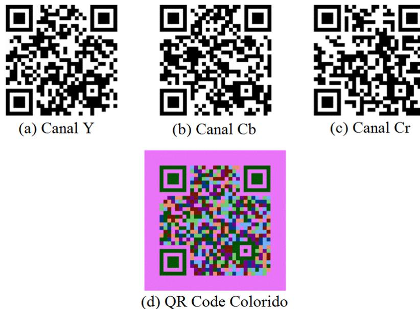
Figura 4.16 – Exemplo de QR Code colorido multiplexado a partir dos canais YCbCr independentes (adaptado de (KIKUCHI; FUJIYOSHI; KIYA, 2013)).
