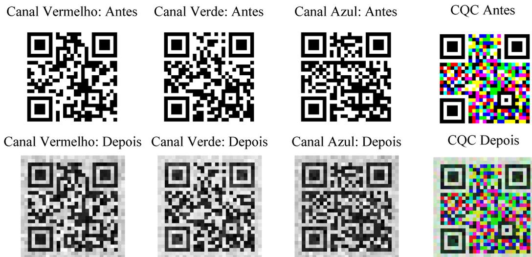
Figura 5.9 – QR Code submetido aos efeitos destrutivos que agem sobre o canal, determinando variações tonais.
