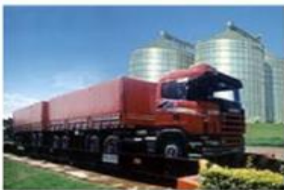
Figura 5 - Sistema de balança rodoviária para pesagem de cargas de grãos em caminhões.
