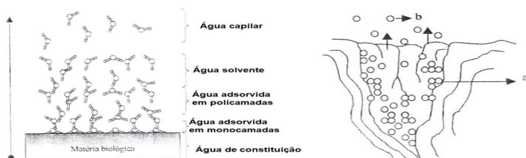
Figura 13 - Representação esquemática das ligações da água e a distribuição das moléculas de água no espaço poroso dos tecidos vegetais.
