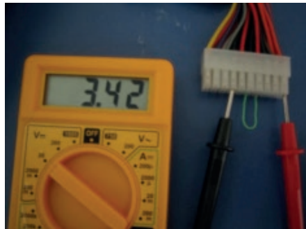
FIGURA 144: Teste de Tensão na Fonte de Alimentação.
