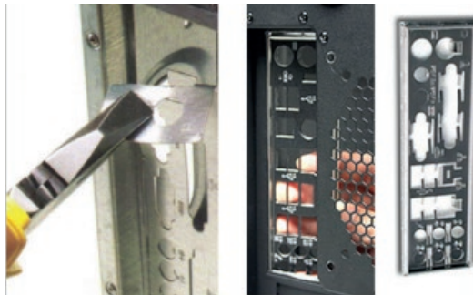
FIGURA 136: Instalando a chapa traseira dos conectores.
