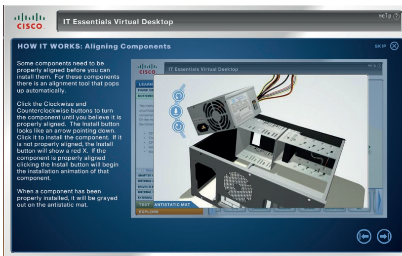
FIGURA 87: Alinhamento de Componentes no Simulador de Desktop.
