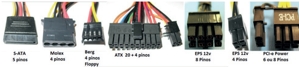
FIGURA 139: Conectores da fonte de alimentação.
