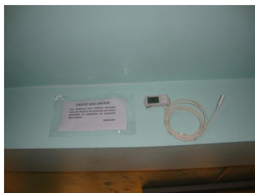
Figura 27 - Registrador instalado na Sala de Estar B.
