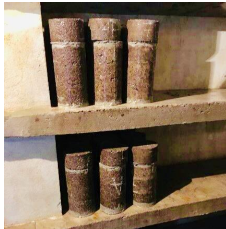
Figura 16 – Corpos de prova em câmara úmida
