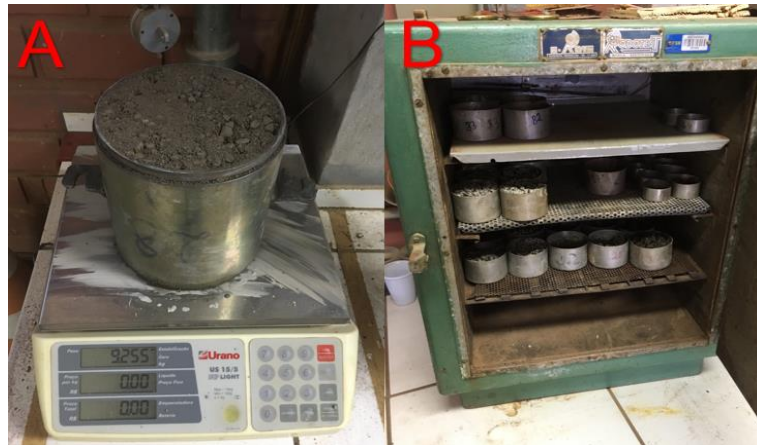
Figura 11 – (A) Pesagem; (B) secagem das amostras
