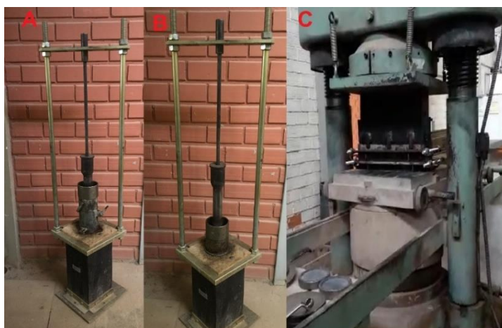
Figura 15 – (A) Compactação ensaio RCS; (B) compactação ensaio RTCD/MR; (C) compactação ensaio RTF
