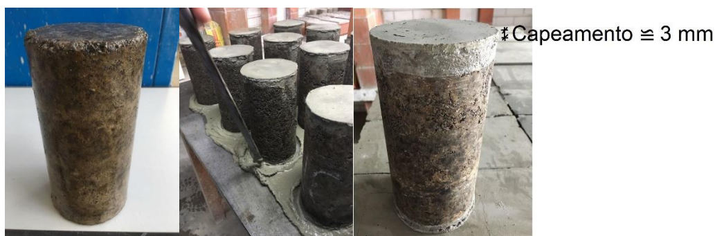
Figura 17 – Capeamento dos corpos de prova 100 x 200 mm
