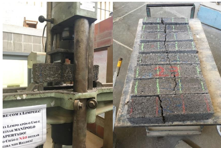
Figura 25 – Vigota pronta para ensaio de RTF e CPs após ruptura
