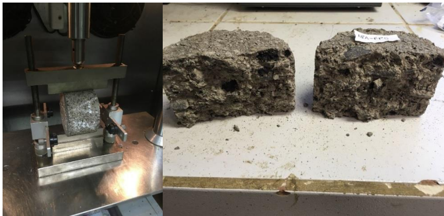
Figura 22 – Amostra pronta para ensaio de RTCD e CP após ruptura
