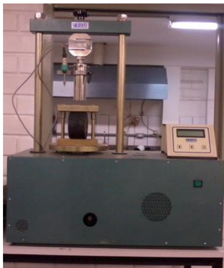
Figura 35 - Equipamento para ensaio de Resistência à Tração
