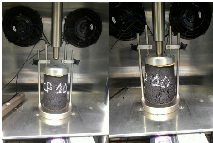
Figura 37 - Imagem da UTM – 25 utilizado no Laboratório de Materiais de Construção Civil e dos corpos de prova antes e depois do ensaio
