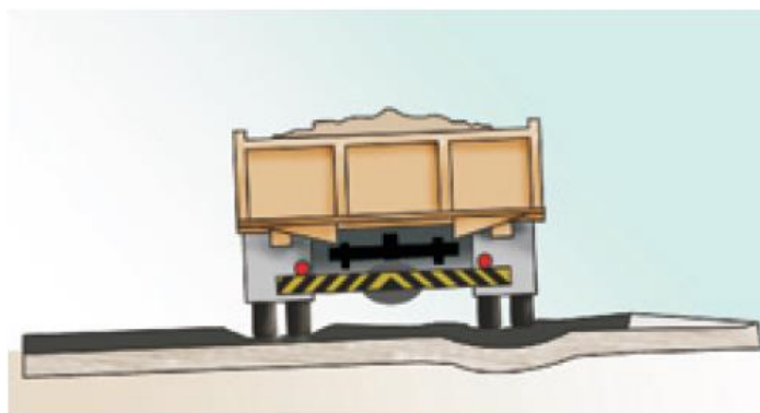
Figura 10 - Deformações permanentes em pavimentos asfálticos
