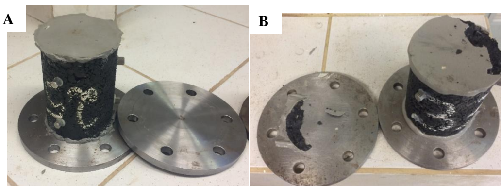
Figura 46 - Problemas de aderência entre as placas de colagem e os corpos de prova
