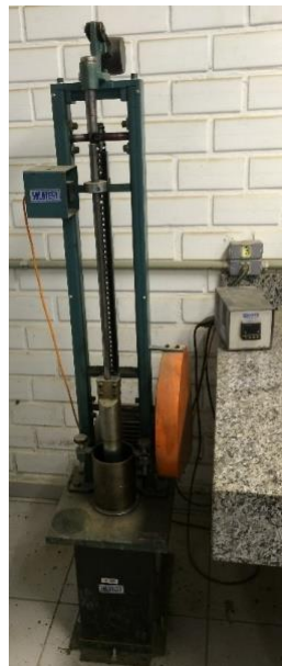
Figura 30 - Exemplo de um compactador por impacto – Laboratório de Materiais de Construção Civil da UFSM
