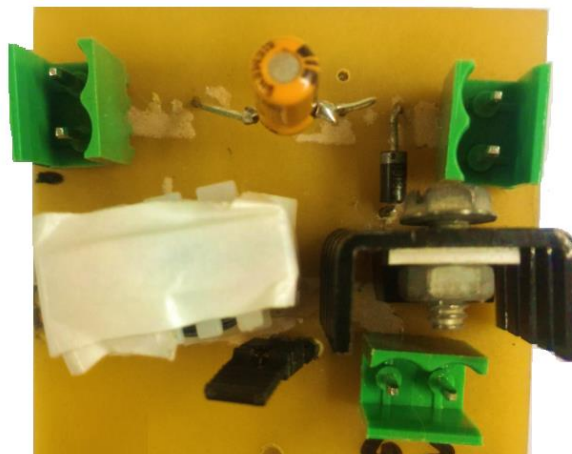
Figura 5.25 - Protótipo do conversor Buck
