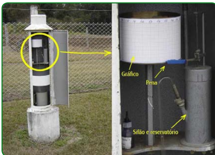
Figura J2 – Pluviógrafo (a) e sistema de registro (b)
