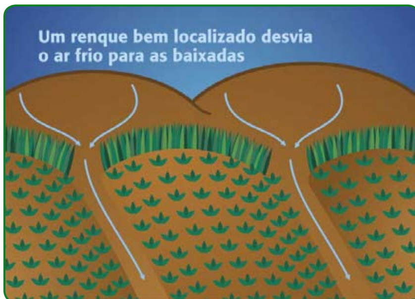
Figura M2 – Localização da barreira de vegetação densa à montante do cultivo que impede a passagem do ar frio (formado à montante) pela cultura e faz com que ele seja desviado para as partes côncavas da encosta por onde ele escoar para a baixada.
