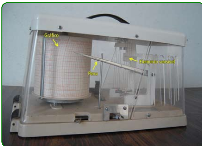
Figura 13 – Higrógrafo (O elemento sensível é constituído por um feixe de cabelos)
