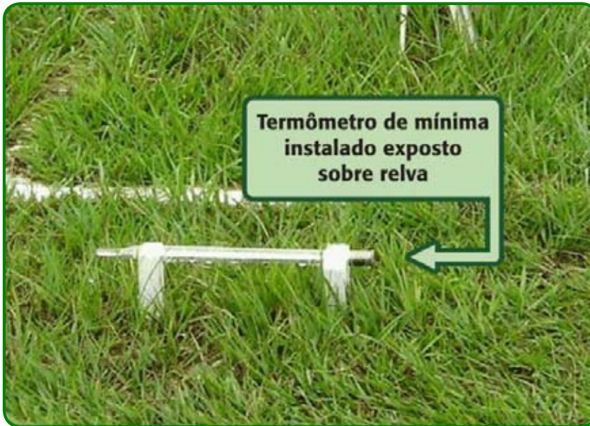
Figura L5. Termômetro de mínima, instalado na altura de 5 cm acima da superfície do solo gramado (relva), exposto a céu aberto para medir a intensidade da geada: seu resfriamento ocorre por contato com o ar frio e, principalmente, pelo processo emissão de energia por radiação. Foto: Arno Bernardo Heldwein, julho de 2000.
