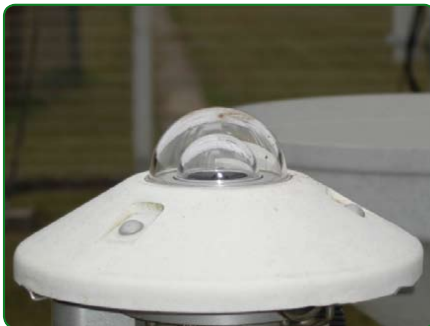
Figura E6 – Pirânometro Kipp & Zonen com cúpula dupla de vidro para filtrar a radiação infravermelha da atmosfera
