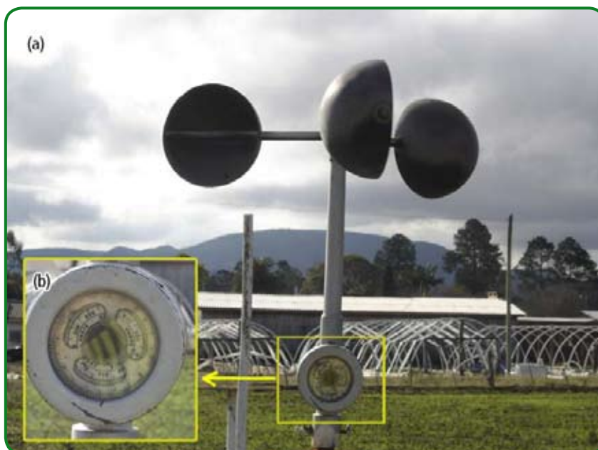
Figura H2 - Anemômetro de caneca (a) e hodômetro (b).
