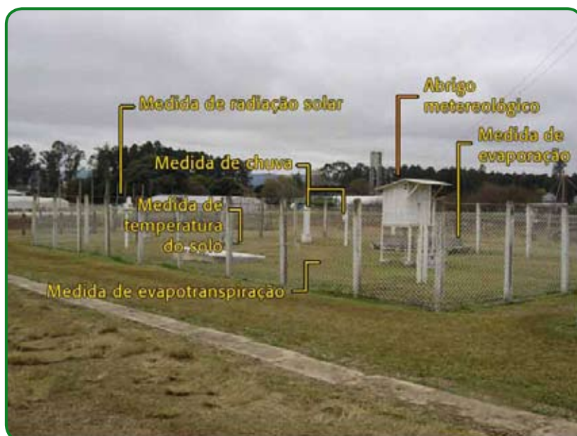
Figura B4. Detalhes distribuição dos instrumentos no interior da Estação Climatológica localizada no Departamento de Fitotecnia da Universidade Federal de Santa Maria
