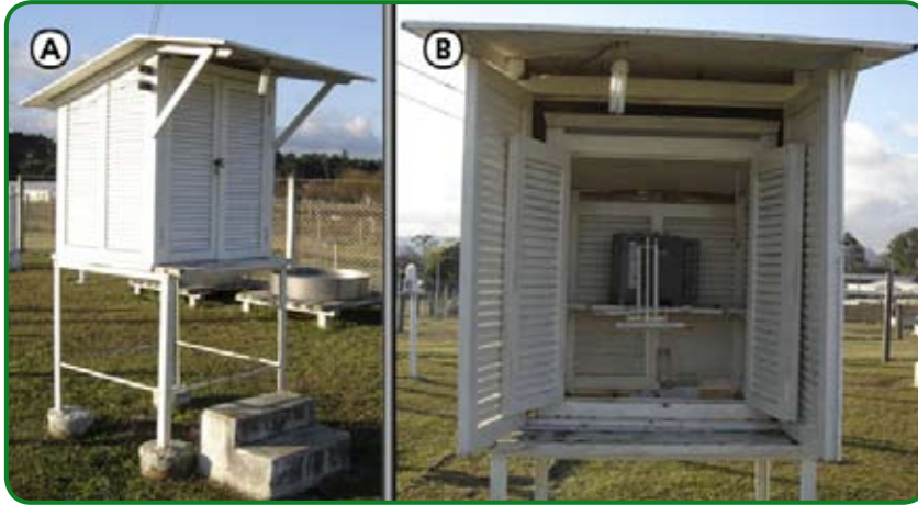
Figura B2 - Abrigo meteorológico ou termométrico (a) e instrumentos de medida de temperatura e umidade do ar e evaporação da ar a sombra (b).
