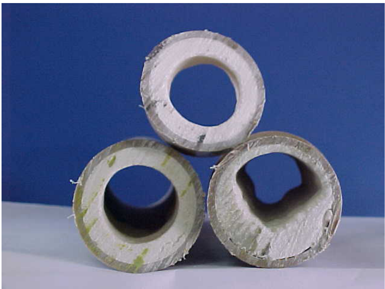
FIGURA 3.5 - Efeito do uso de água com alta concentração de sais sobre tubulação de PVC. Imagem: Adroaldo Dias Robaina e Marcia Xavier Peiter
