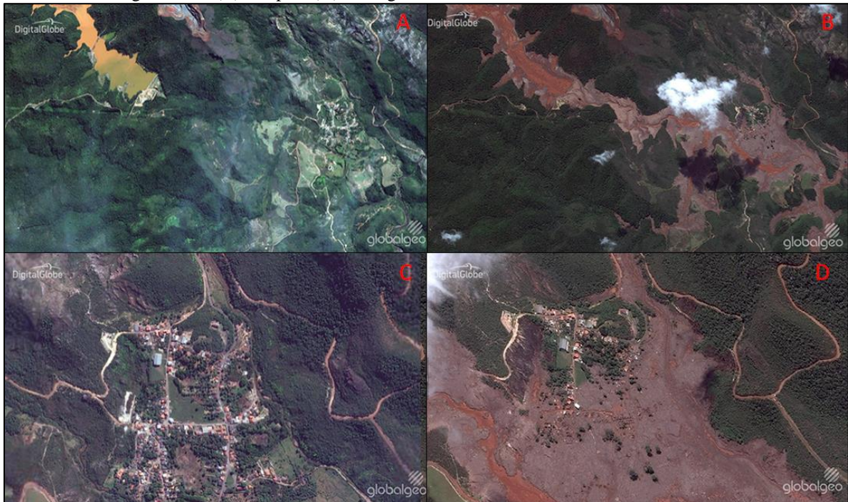
Figura 23 – Barragem de Fundão e Santarém antes (A) e depois (B) do rompimento da barragem e subdistrito de Bento Rodrigues antes (C) e depois (D) da tragédia.
