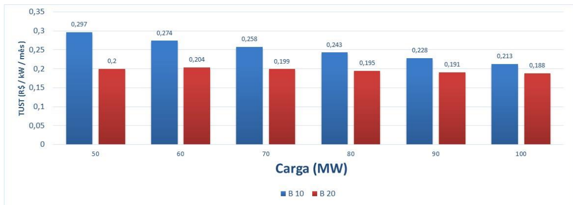
Gráfico 20 - TUST de geração modificando-se a Carga 40 e o Gerador 20
