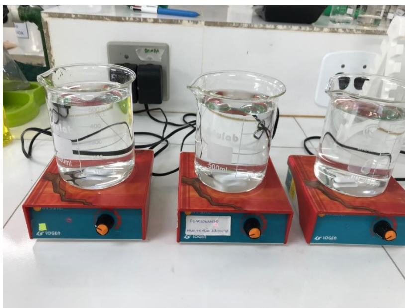
Figura 11 - Teste de desinfecção com cloro
