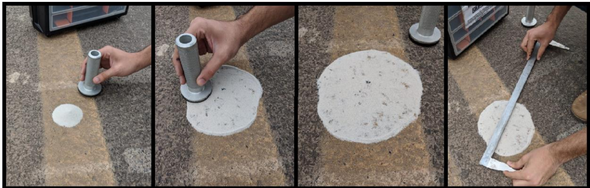
Figura 21 – Levantamento de mancha de areia realizado sobre a sinalização.
