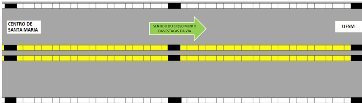
Figura 20 - Pontos com acompanhamento da macrotextura desde a pintura (em preto).
