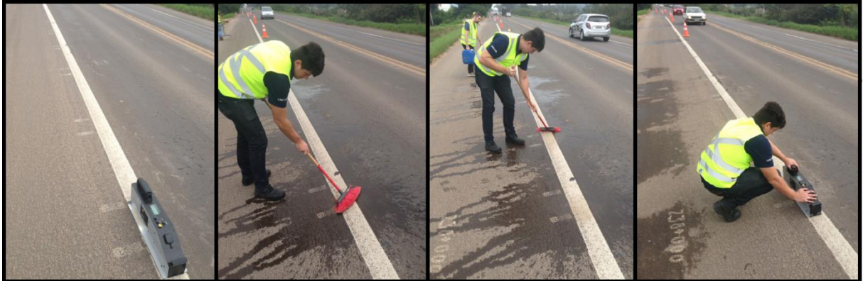
Figura 26 - Retrorefletividade pré e após limpeza.
