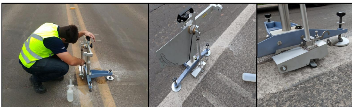
Figura 22 - Levantamento de Pêndulo Britânico sendo realizado sobre as demarcações.
